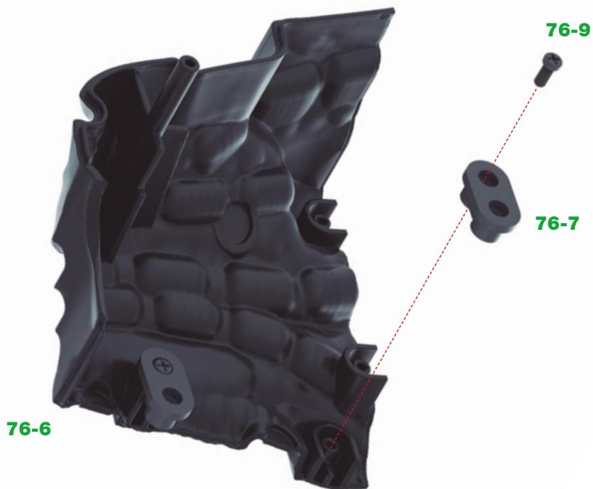
**6** Stecken Sie das verbleibende Verbindungsstück **76-7** auf den freien Zapfen rechts von dem Verbindungsstück, das Sie in Schritt 5 befestigt haben. Befestigen Sie das Teil mit einer **76-9** Schraube. ◀
