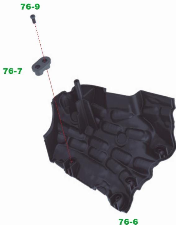
**5** Nehmen Sie das Teil des Abdomens **76-6** wieder zur Hand. Stecken Sie ein Verbindungsstück **76-7** in den Zapfen an der auf der Abbildung markierten Stelle am inneren Teil des Abdomens. Befestigen Sie das Teil mit einer **76-9** Schraube. ◀
