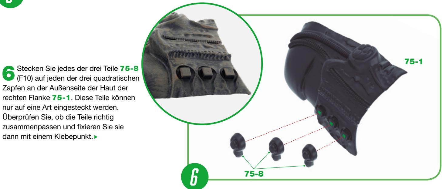
**6** Stecken Sie jedes der drei Teile **75-8** (F10) auf jeden der drei quadratischen Zapfen an der Außenseite der Haut der rechten Flanke **75-1**. Diese Teile können nur auf eine Art eingesteckt werden. Überprüfen Sie, ob die Teile richtig zusammenpassen und fixieren Sie sie dann mit einem Klebepunkt. ▶
