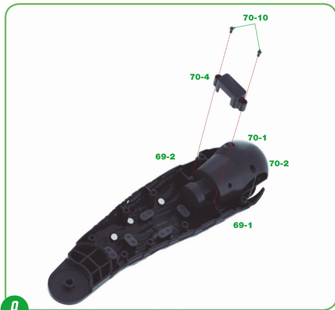
**9** Befestigen Sie die Baugruppe, indem Sie das Befestigungsstück **70-4** auf den dünneren Teil des Endes der Verbindungsstücke **70-1** und **70-2** setzen. Befestigen Sie die Baugruppe mit zwei Schrauben **70-10**. ◀
