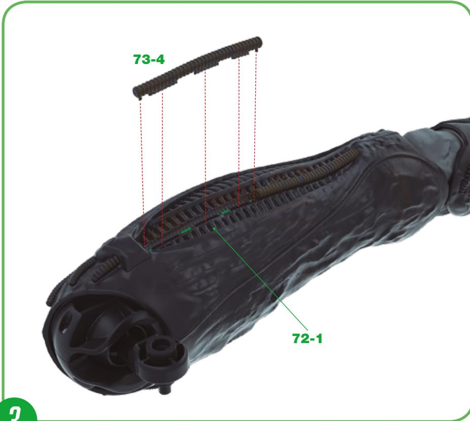
**3** Stecken Sie nun die Laschen und Zapfen des Schlauchs der Haut des linken Oberschenkels **73-4** (D2) in die freigebliebenen Schlitz und Löcher der Haut des linken Oberschenkels **72-1**. Der Schlauch **73-4** kann nur auf eine Art zusammengesteckt werden. Kleben Sie die Teile zusammen, nachdem Sie sich vergewissert haben, dass sie richtig zusammenpassen. ◀
