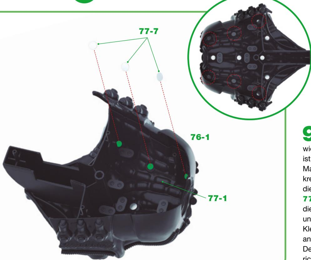
**9** Halten Sie die Haut der linken Flanke **76-1** so fest, wie es in Schritt 8 beschrieben ist, und bringen Sie drei Magnete **77-7** in den kreisförmigen Vertiefungen an, die sich auf dem Abdomenteil **77-1** befinden. Überprüfen Sie die Ausrichtung der Magnetpole und befestigen Sie sie mit einem Klebepunkt. Orientieren Sie sich an der Abbildung und der Detailansicht, um die Magneten richtig zu positionieren. ◀
