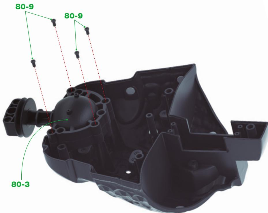
**5** Befestigen Sie die beiden Teile mit vier Schrauben **80-9** aneinander, wie in der Abbildung gezeigt. ◀
