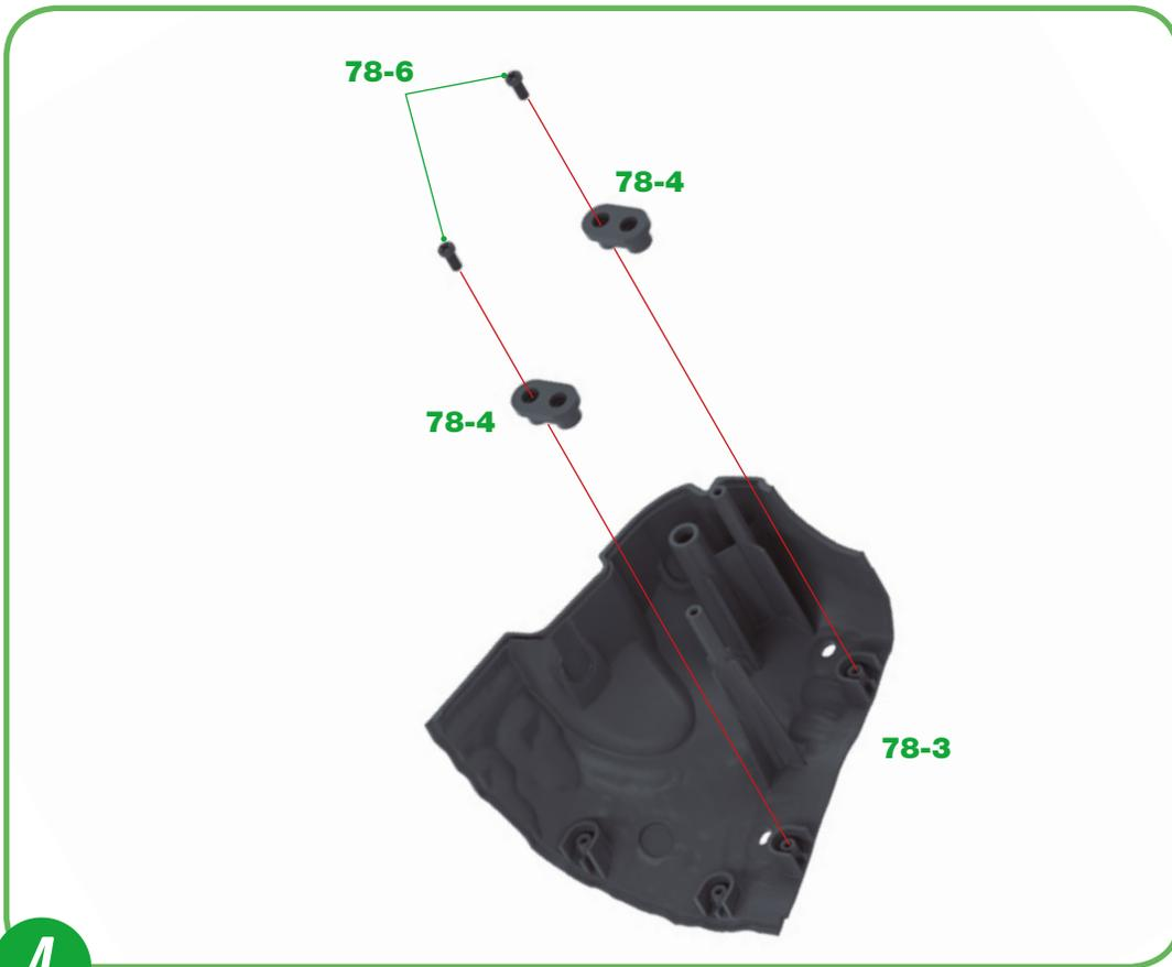
**4** Nehmen Sie das Abdomenteil **78-3** zur Hand und setzen Sie die beiden Verbindungsstücke **78-4** in die beiden dafür vorgesehenen Steckverbindungen ein, wie in der Abbildung gezeigt. Befestigen Sie jedes Teil mit einer Schraube **78-6**. ◀
