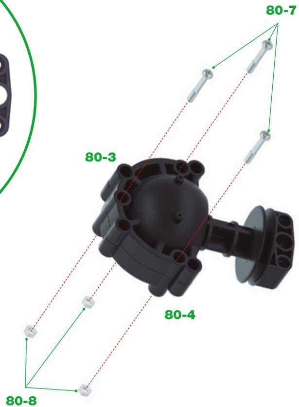
**3** Während Sie die Baugruppe von Schritt 2 in Position halten, führen Sie die drei Muttern **80-8** in die drei Löcher des Schutzes **80-4** ein und befestigen Sie sie dann mit den drei Schrauben **80-7**, indem Sie diese in die entsprechenden Löcher des Schutzes **80-3** einführen. Orientieren Sie sich an der Abbildung und der Detailansicht, um Ihre Teile richtig auszurichten. ▶
