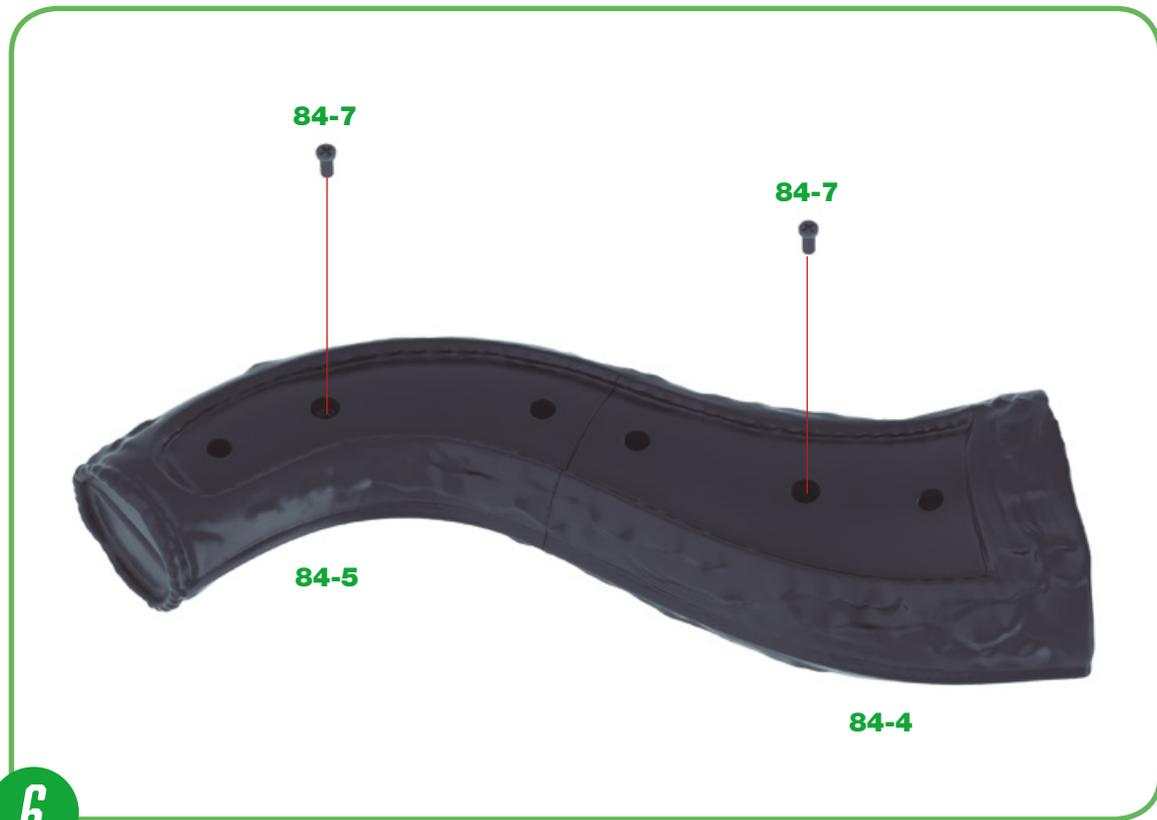
**6** Drehen Sie die Baugruppe von Schritt 5 um und befestigen Sie die Teile mit zwei Schrauben **84-7** aneinander, die Sie in die mittleren Löcher der Teile **84-4** und **84-5** einführen, wie in der Abbildung gezeigt. ◀
