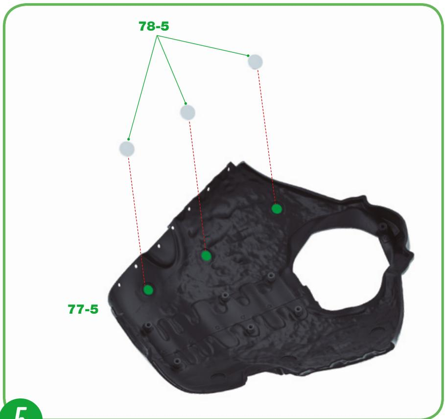
**5** Nehmen Sie jetzt die Baugruppe aus Schritt 2 wieder zur Hand, drehen Sie sie um und setzen Sie drei Magnete **78-5** in die kreisförmigen Vertiefungen auf der Innenseite der Haut des Abdomens **77-5** ein, die in der Abbildung gezeigt werden. Befestigen Sie sie mit einem Klebepunkt. Beim Anbringen der Magnete muss keine bestimmte Ausrichtung beachtet werden. ▶
