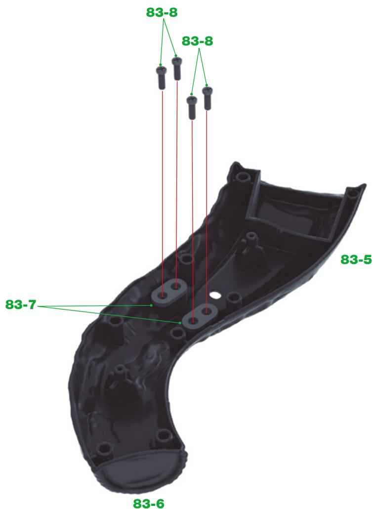
**5** Befestigen Sie die Verbindungsstücke **83-7** mit vier Schrauben **83-8**. ◀
