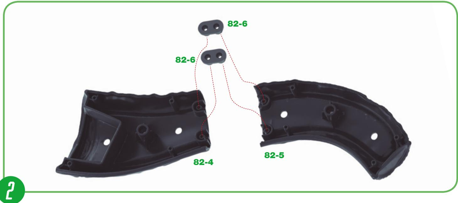
**2** Nehmen Sie die Rückenteile **82-4** und **82-5** und setzen Sie zwei Verbindungsstücke **82-6** in die beiden Steckverbindungen zwischen den Rückenteilen ein, um diese miteinander zu verbinden. ▲
