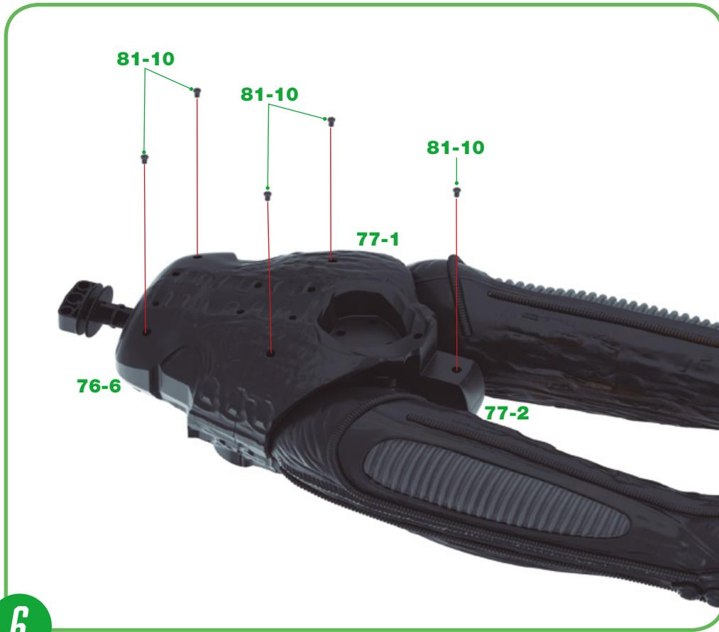
**6** Befestigen Sie die Teile, die Sie soeben zusammengesetzt haben, mit fünf Schrauben **81-10**: zwei Schrauben auf Teil **76-6**, zwei weitere Schrauben auf Teil **77-1** und eine Schraube auf dem unteren Teil von **77-2**. Orientieren Sie sich an der nebenstehenden Abbildung, um die Teile richtig aneinander zu befestigen. ◀
