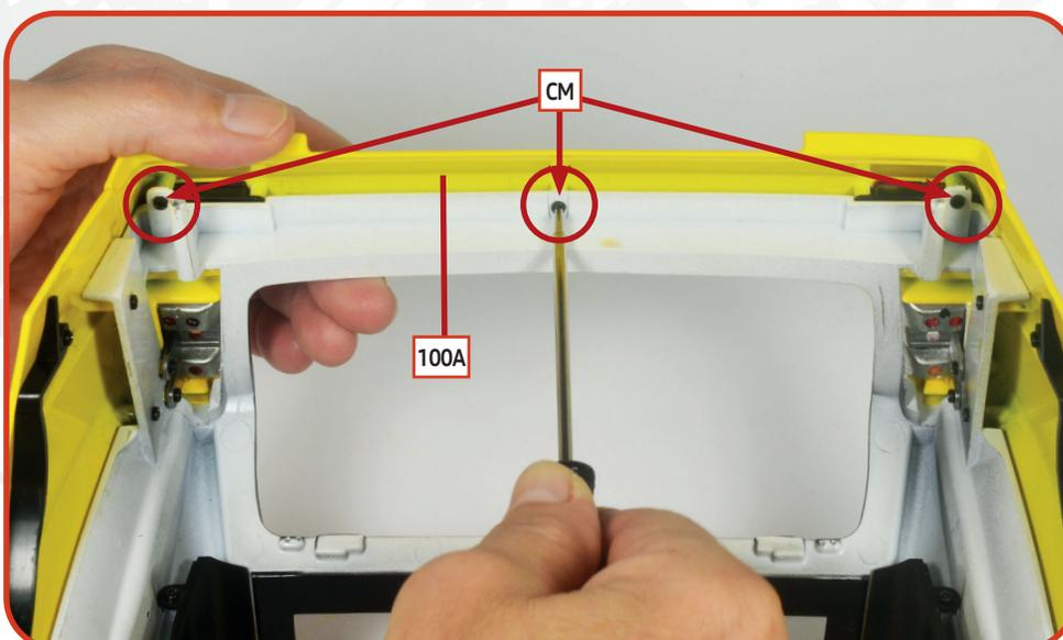
**03** Nehmen Sie die Karosserie Ihres Modells wieder zur Hand, legen Sie sie umgedreht auf Ihre Arbeitsfläche und befestigen Sie die Heckstoßstange **100A** an der Karosserie. Richten Sie die Teile wie abgebildet aus und befestigen Sie die Teile, indem Sie drei **CM**-Schrauben in den angezeigten Löchern anziehen.
