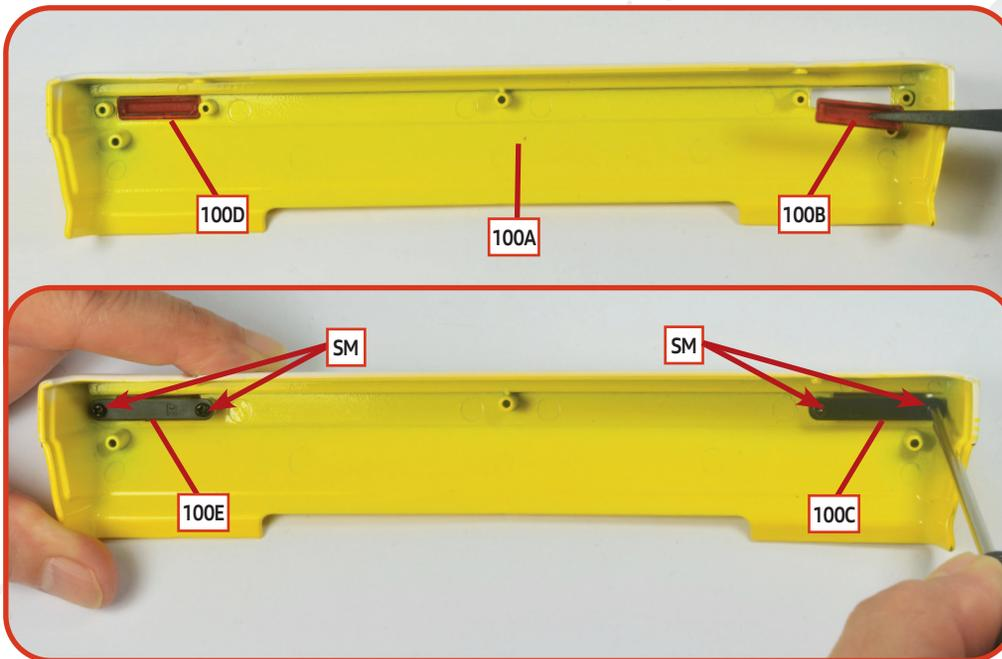
**01** Setzen Sie den linken und rechten Rückstrahler (**100B** und **100D**) an den dafür vorgesehenen Stellen an der Innenseite der hinteren Stoßstange **100A** ein. Montieren Sie die linke und rechte Halterung (**100C** und **100E**) auf den jeweiligen Rückstrahler und befestigen Sie sie mit vier **SM**-Schrauben (zwei pro Halterung).
