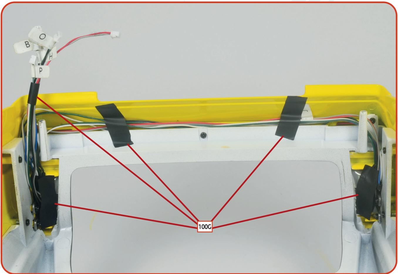
**06** Legen Sie jetzt die Kabel vorsichtig wie auf dem Foto gezeigt an der Innenseite der hinteren Stoßstange entlang. Bündeln Sie sie und befestigen Sie sie mit den fünf Klebestreifen **100G**.
