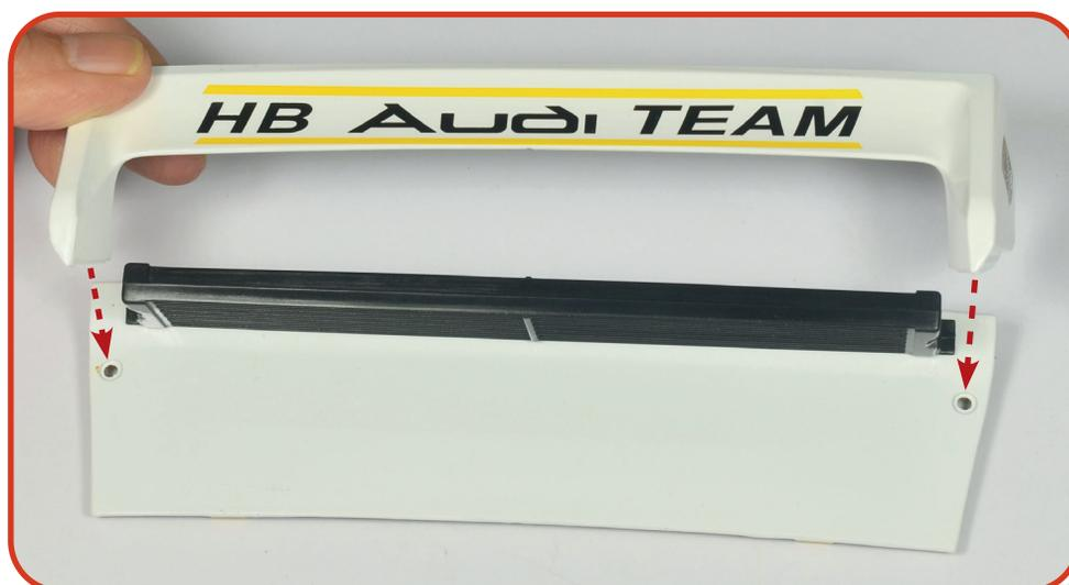
**04** Nehmen Sie den Heckspoiler, den Sie in Bauphase 103 zusammengebaut haben, zur Hand. Bringen Sie den Spoiler an der Oberseite der Heckklappe an, indem Sie die Teile wie gezeigt ausrichten und die gebohrten Zapfen des Spoilers in die Löcher der Heckklappe stecken.
