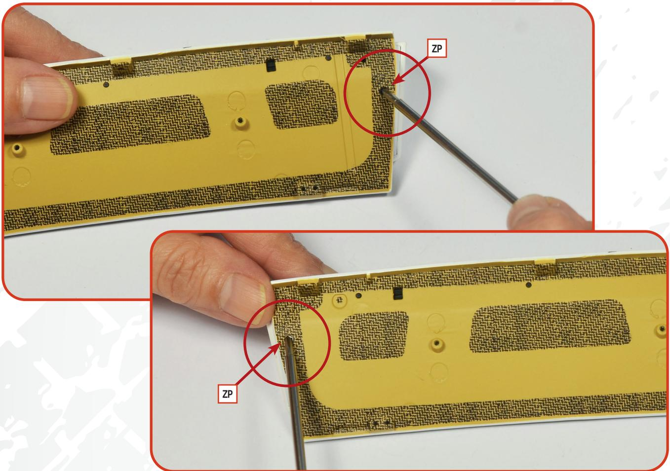
**05** Befestigen Sie den Spoiler an der Heckklappe, indem Sie zwei **ZP**-Schrauben in den auf dem Foto markierten Löchern an der Unterseite der Heckklappe anziehen.
