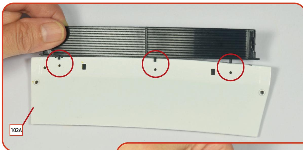
**03** Nehmen Sie die Heckklappe **102A** zur Hand, an der Sie in Bauphase 102 gearbeitet haben. Bringen Sie den hinteren Kühler an der angezeigten Stelle an, indem Sie die Stifte in die entsprechenden Löcher an der Oberseite der Heckklappe stecken. Das Bauteil **104B** muss auf die hintere Kante der Heckklappe gesteckt werden, die die Schriftzüge „Audi“ und „quattro“ tragen.
