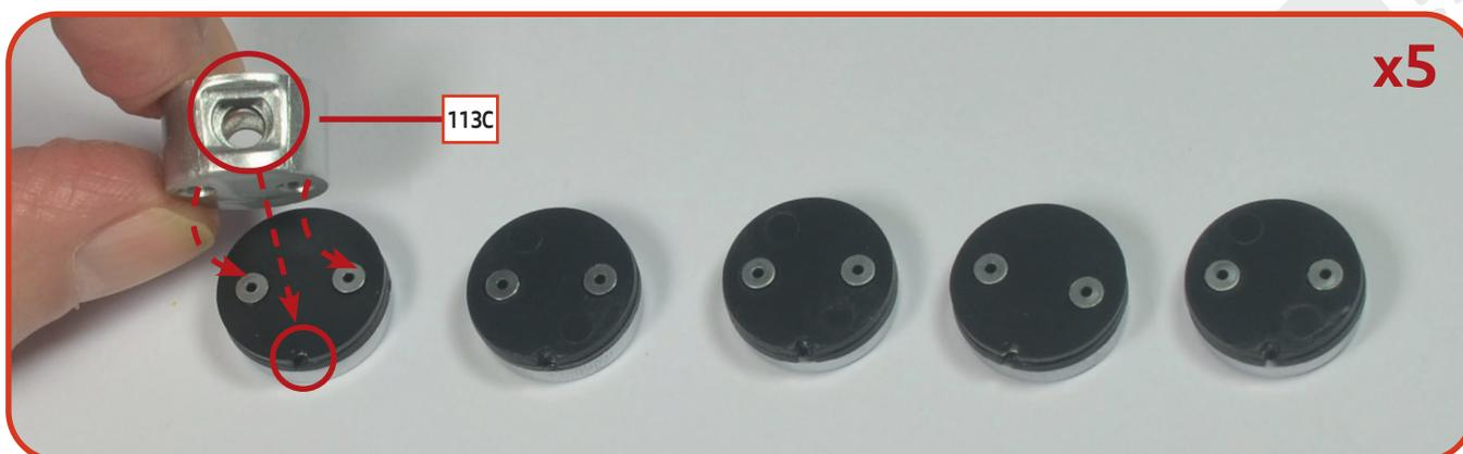
**05** Setzen Sie nun je einen Kolben **113C** auf die Innenseite jedes Kolbendachs. Achten Sie darauf, dass die halbmondförmige Aussparung des Kolbens genau mit den Ösen der Kolbenringe übereinstimmt.
