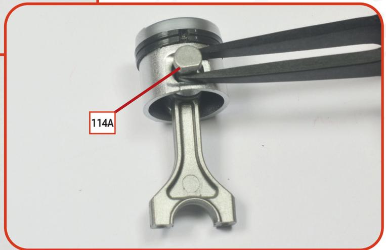
**02** Befestigen Sie die Bauteile, indem Sie eine **ABP**-Schraube in das runde Loch auf der gegenüberliegenden Seite des Kolbens eindrehen. Ziehen Sie die Schraube nicht vollständig an – der Kolben muss sich auf der Pleuelstange frei bewegen können.
