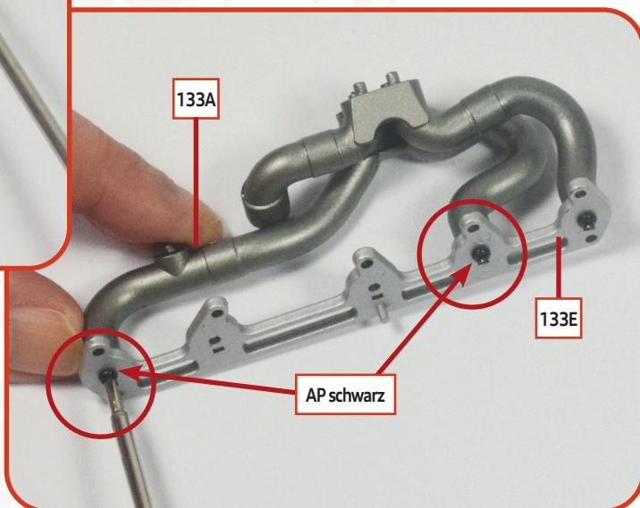
**01** Verbinden Sie den Auspuffkrümmer 3 (133C) und den Auspuffkrümmer 1 (133A) mit dem Flansch 133E, indem Sie die Teile wie auf den Fotos ausrichten. Verwenden Sie drei schwarze AP-Schrauben, um die Bauteile wie abgebildet zu fixieren.
