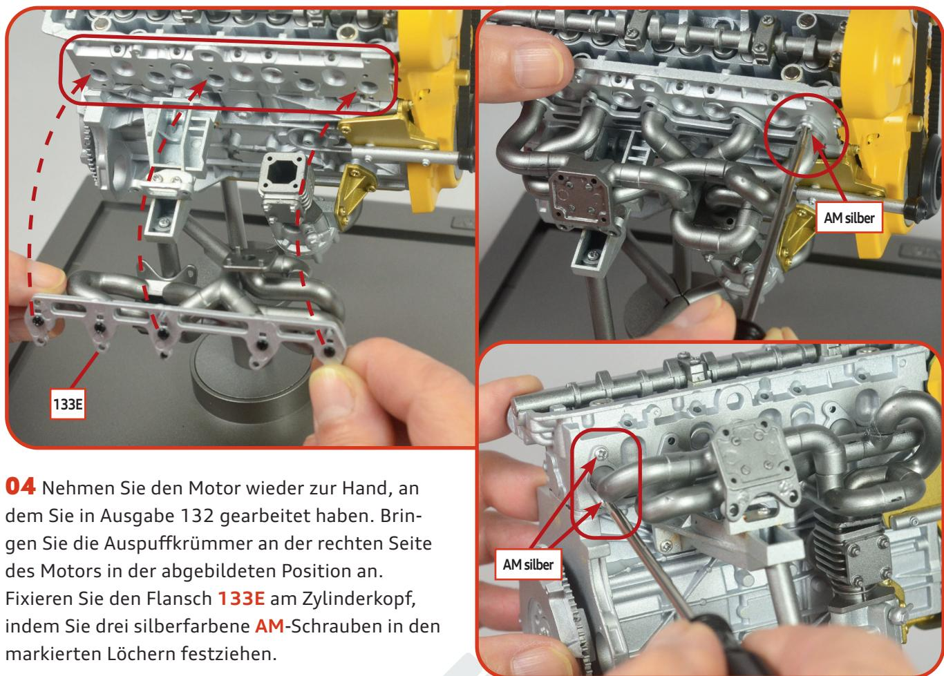
**04** Nehmen Sie den Motor wieder zur Hand, an dem Sie in Ausgabe 132 gearbeitet haben. Bringen Sie die Auspuffkrümmer an der rechten Seite des Motors in der abgebildeten Position an. Fixieren Sie den Flansch **133E** am Zylinderkopf, indem Sie drei silberfarbene **AM**-Schrauben in den markierten Löchern festziehen.
