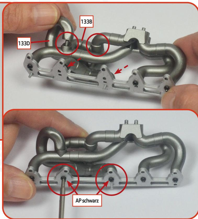
**02** Führen Sie den Zapfen des Auspuffkrümmers 2 (133B) in die gebohrte Aufnahme des Auspuffkrümmers 4 (133D) ein, wie auf dem ersten Bild gezeigt. Verbinden Sie diese Baugruppe mit den restlichen Auspuffkrümmern und befestigen Sie die Teile mit zwei schwarzen AP-Schrauben.
