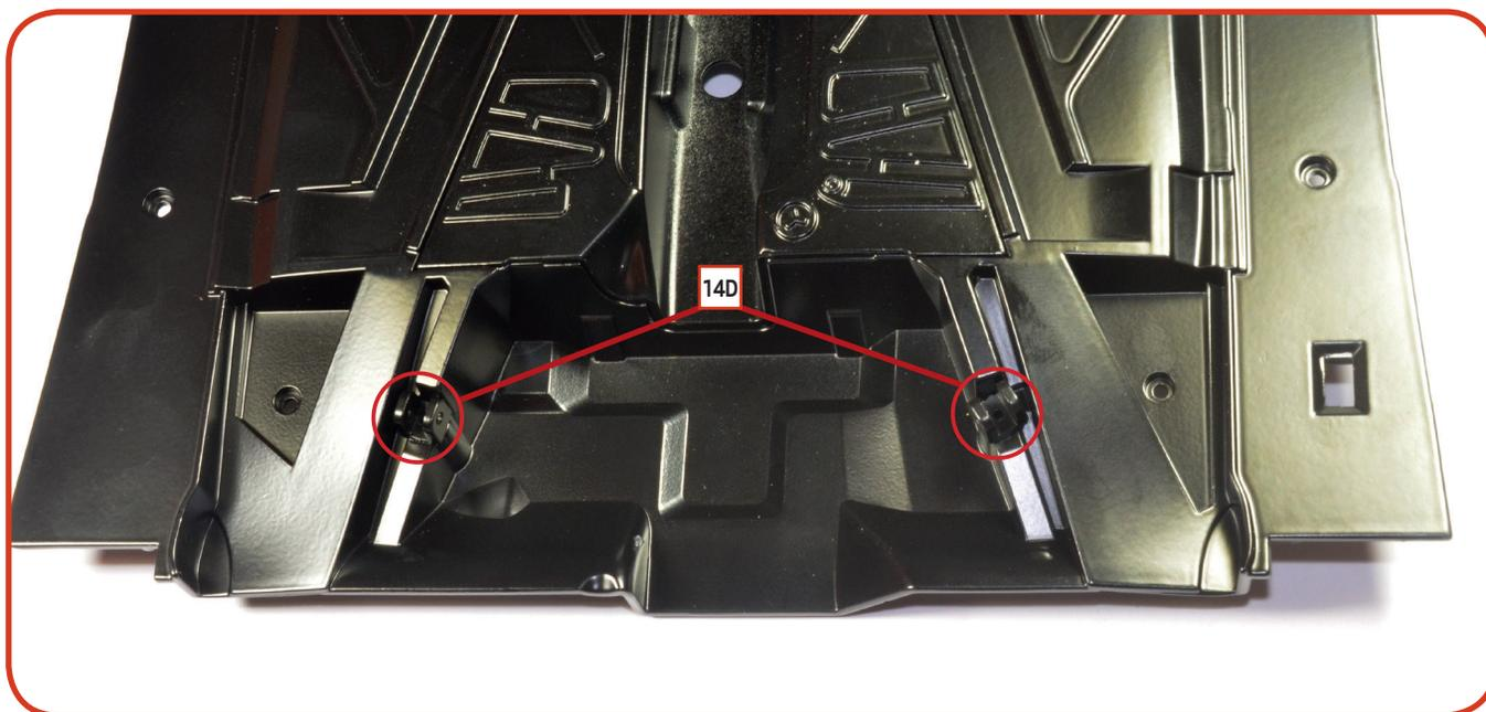
**04** Stecken Sie die beiden Halterungen **14D** in die entsprechenden Schlitz an der Oberseite der Bodenplatte.
