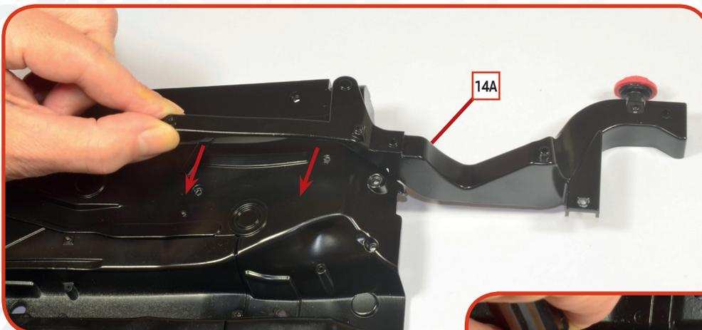
**02** Nehmen Sie jetzt den vorderen Teil der Bodenplatte wieder zur Hand, den Sie in Ausgabe 13 bearbeitet haben. Arbeiten Sie an der Unterseite der Bodenplatte und bringen Sie den rechten Hilfsrahmen **14A** in der auf dem Foto gezeigten Position an. Drehen Sie die Baugruppe auf den Kopf und befestigen Sie die Teile aneinander, indem Sie drei **CM**-Schrauben in den angegebenen Löchern anziehen.
