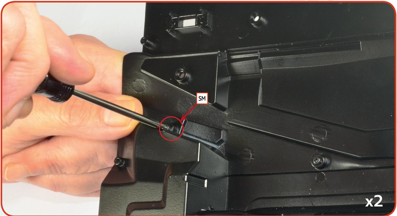
**05** Befestigen Sie die beiden Halterungen, indem Sie zwei **SM**-Schrauben (eine pro Halterung) in den entsprechenden Löchern auf der Oberseite der Bodenplatte anziehen.
