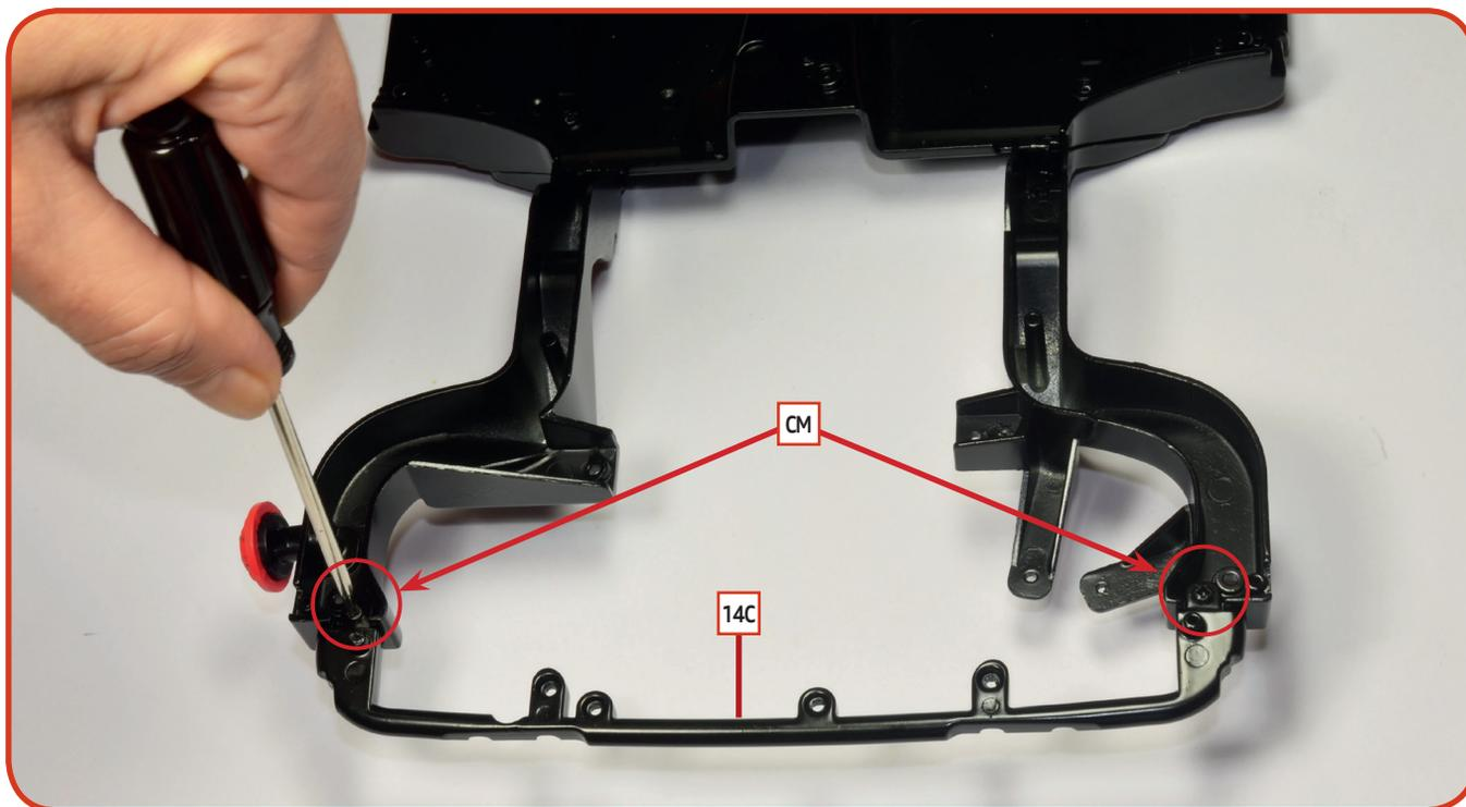
**03** Bringen Sie die Querstange **14C** an den vorderen Enden der Hilfsrahmen an und befestigen Sie sie mit zwei **CM**-Schrauben.
