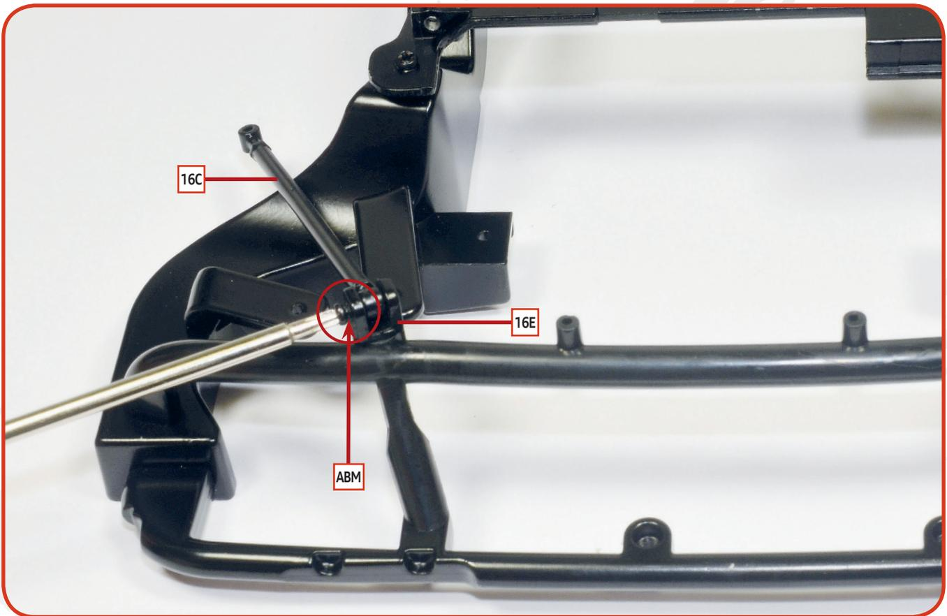
**06** Zum Schluss stecken Sie ein Ende der anderen Zugstange **16C** in die verbleibende freie Gabel **16E** und befestigen die Teile mit einer **ABM**-Schraube.
