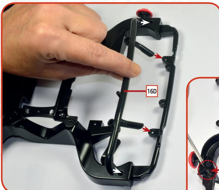
**03** Bringen Sie die untere Querstange **16D** wie abgebildet an und befestigen Sie sie, indem Sie vier **AP**-Schrauben in den markierten Löchern anziehen.
