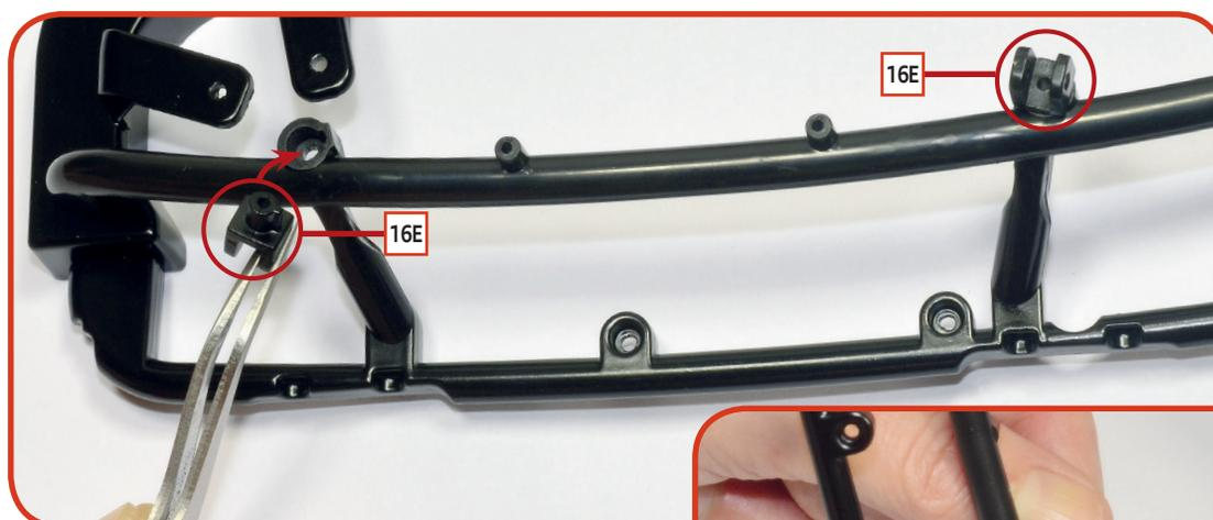
**04** Setzen Sie die beiden **16E**-Gabeln in die entsprechenden Schlitze der Querstange ein und verwenden Sie zwei **AM**-Schrauben (eine pro Gabel), um sie zu befestigen.
