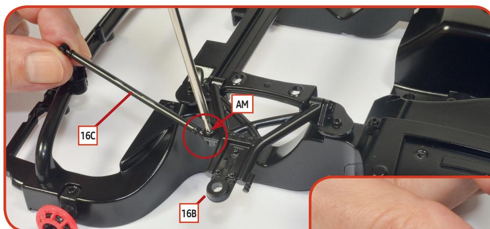
**05** Platzieren Sie eine der Enden einer Zugstange **16C** an der gebohrten Halterung des Arms **16B** und befestigen Sie die Teile mit einer **AM**-Schraube. Stecken Sie dann das andere Ende der gleichen Zugstange in die nächstgelegene **16E**-Gabel und ziehen Sie sie mit einer **ABM**-Schraube in der markierten Bohrung fest.
