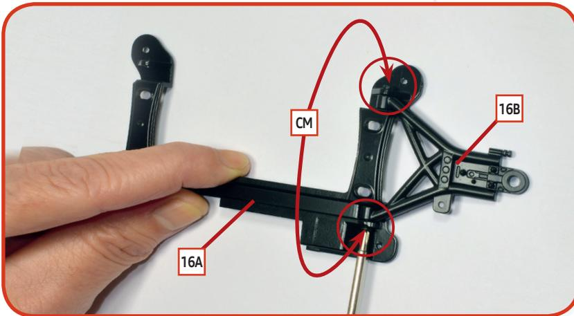
**01** Fügen Sie den Querlenker **16B** und den Hilfsrahmen **16A** zusammen und richten Sie die Teile wie gezeigt aus. Ziehen Sie zwei **CM**-Schrauben in den markierten Löchern an, um sie zu befestigen.
