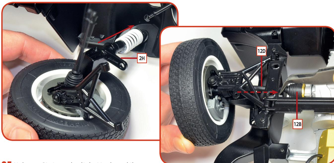
**05** Nehmen Sie jetzt das linke Vorderrad Ihres Modells wieder zur Hand. Montieren Sie es wie auf den Fotos gezeigt an der Bodenwanne, indem Sie die Stange des Stoßdämpfers in das entsprechende Loch in der **2H**-Spindel und das freie Ende der **12D**-Achswelle in die **12B**-Kappe einführen.
