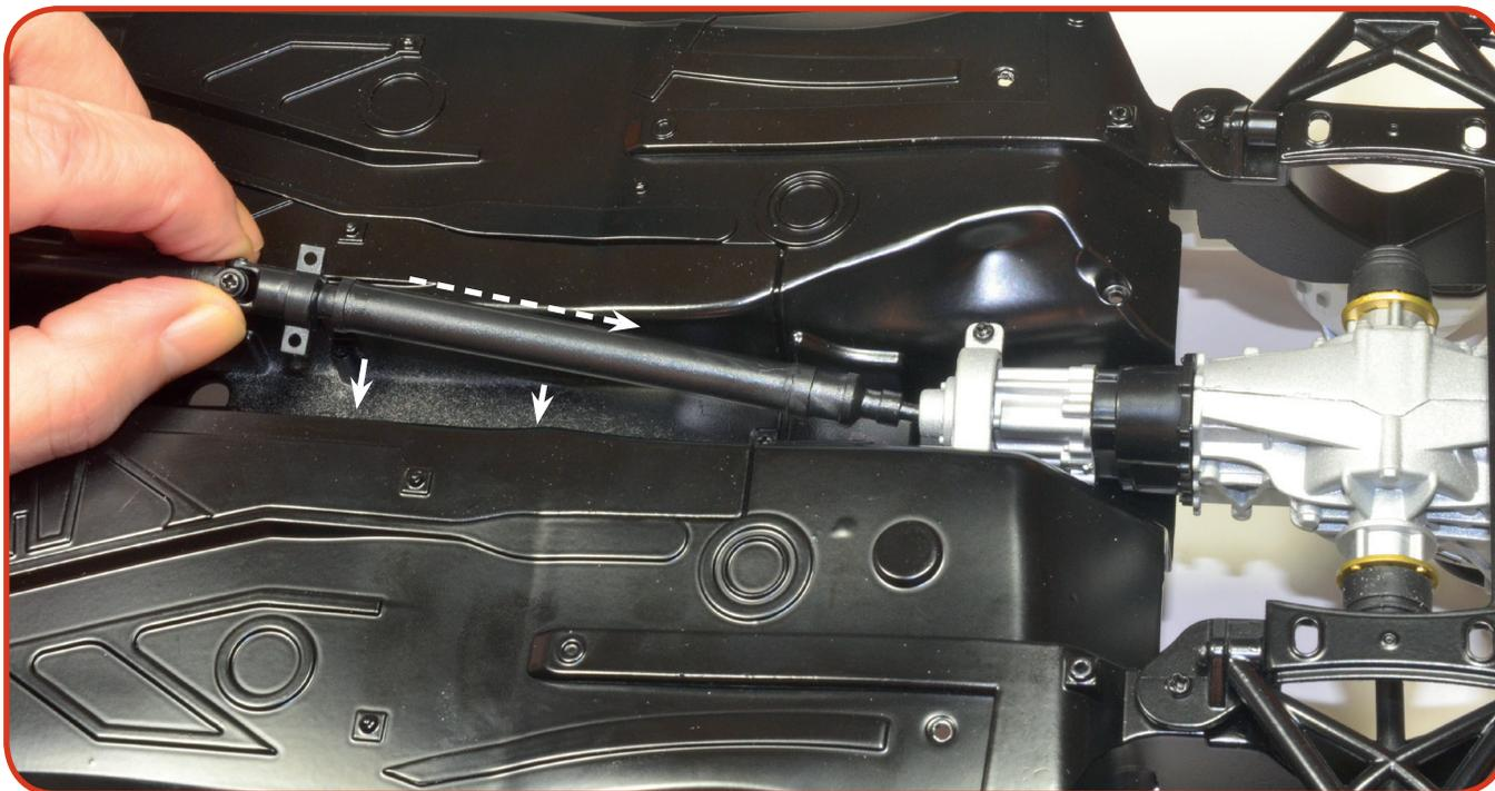
**02** Nehmen Sie die Bodenplatte Ihres Modells wieder zur Hand und legen Sie sie mit der Unterseite nach oben auf Ihre Arbeitsfläche. Stecken Sie das freie Ende des Vorderteils der Kardanwelle in den Motoranschluss und setzen Sie den Rest der Welle in den Mitteltunnel ein.
