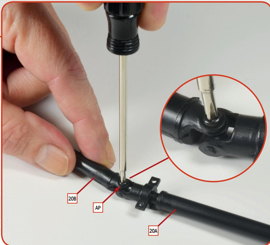
**01** Legen Sie eine **AP**-Schraube und die beiden Teile der Kardanwelle (**20A** und **20B**), die Sie mit dieser Bauphase erhalten haben, auf Ihre Arbeitsfläche. Richten Sie die Teile wie gezeigt aus und fügen Sie sie zusammen, indem Sie die Öse des Hinterteils **20B** in den gebohrten Stift des Kreuzgelenks am Ende des Vorderteils **20A** einfügen. Verwenden Sie die **AP**-Schraube, um die beiden Teile miteinander zu verbinden.
