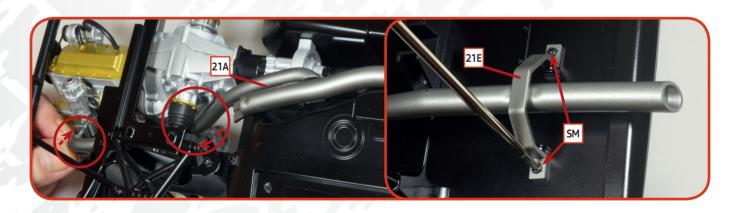
03 Nehmen Sie die Bodenplatte Ihres Modells heraus und legen Sie sie mit der Unterseite nach oben auf Ihre Arbeitsfläche. Platzieren Sie das Auspuffrohr im Mitteltunnel und führen Sie den Auspuff 21A unter dem rechten Vorderachsgelenk und dem Rahmen hindurch. Stecken Sie den Stift am Ende des Auspuffs 21A in das Loch an der Seite des Wastegate-Ventils. Befestigen Sie anschließend das Ende der Auspuffteile mit dem Befestigungswinkel 21E und zwei SM-Schrauben am hinteren Teil der Bodenplatte.
