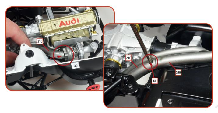
Drehen Sie die Bodenplatte herum und stecken Sie den Stift an einem Ende des Rohrs **21C** in die seitliche Öffnung des Turboladers, wobei Sie die Teile wie gezeigt ausrichten. Drehen Sie die Baugruppe wieder zurück, verbinden Sie das andere Ende des Rohrs mit dem freien Ende des Auspuffteils **21B** und befestigen Sie die Teile aneinander, indem Sie eine **KP**-Schraube in dem angegebenen Loch festziehen.
