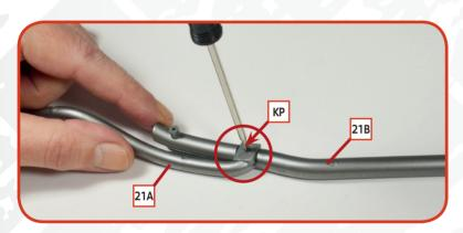
**02** Stecken Sie die gelochte Halterung am Ende des Auspuffs des Wastegate-Ventils **21A** auf das Mittelteil **21B**. Verwenden Sie eine weitere **KP**-Schraube, um die Teile miteinander zu verbinden.
