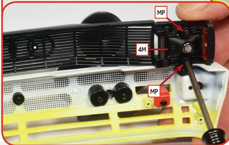
**05** Verbinden Sie die Glasabdeckungen der Scheinwerfer **4N** und **40** mit den Gehäusen **4L** und **4M**. Setzen Sie die Blinker **4P** und **4Q** in die jeweiligen Scheinwerfergehäuse ein, positionieren Sie die Scheinwerfer und befestigen Sie sie mit vier **MP**-Schrauben (zwei pro Scheinwerfer) an den Gehäusen.
