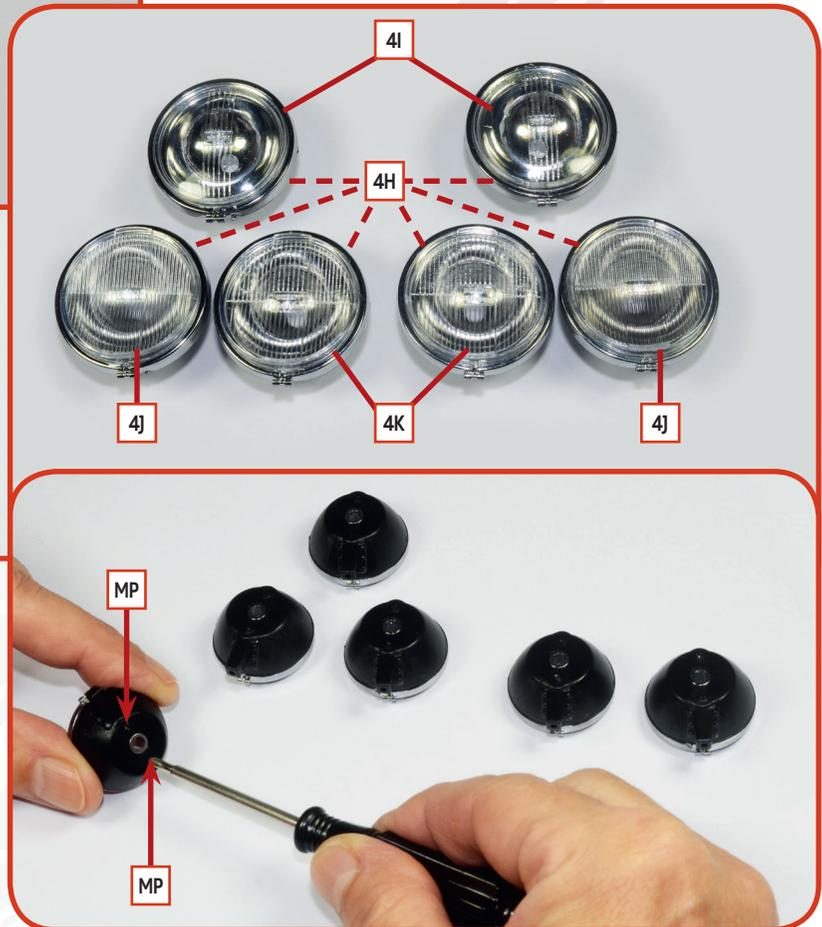
**01** Drücken Sie die Glasabdeckungen **4I** (Bosch-Logo, Streifen nur in der Mitte), **4J** (Bosch-Logo, Streifen auf dem ganzen Glas) und **4K** (Bosch Halogen-Logo) auf die Gehäuse **4H** und verbinden Sie sie mit ihren Schalen **4G**, wobei Sie die Teile wie gezeigt ausrichten. Befestigen Sie die Gehäuse mit zwölf **MP**-Schrauben (zwei pro Gehäuse) an den Schalen.
