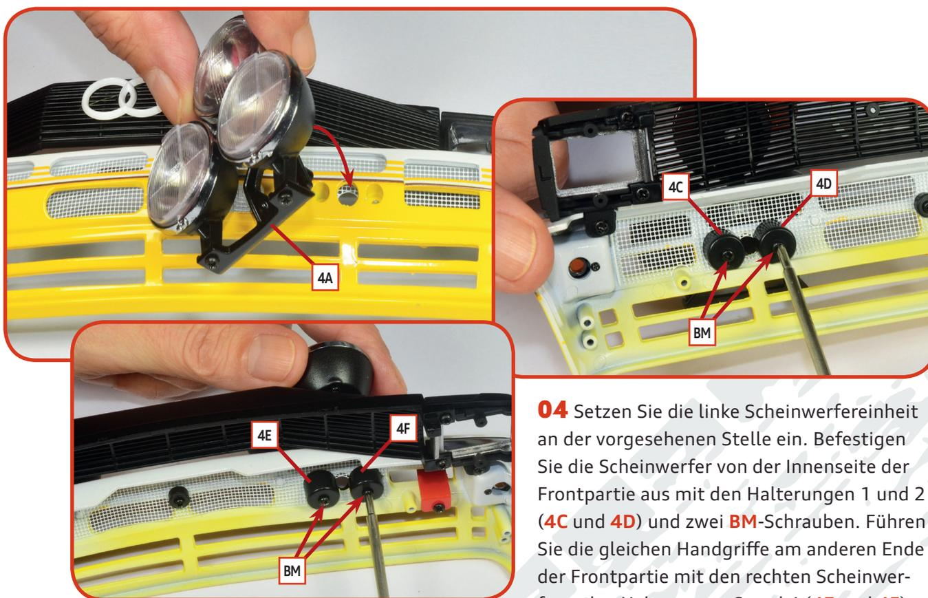
**04** Setzen Sie die linke Scheinwerfereinheit an der vorgesehenen Stelle ein. Befestigen Sie die Scheinwerfer von der Innenseite der Frontpartie aus mit den Halterungen 1 und 2 (**4C** und **4D**) und zwei **BM**-Schrauben. Führen Sie die gleichen Handgriffe am anderen Ende der Frontpartie mit den rechten Scheinwerfern, den Halterungen 3 und 4 (**4E** und **4F**) und zwei weiteren **BM**-Schrauben durch.
