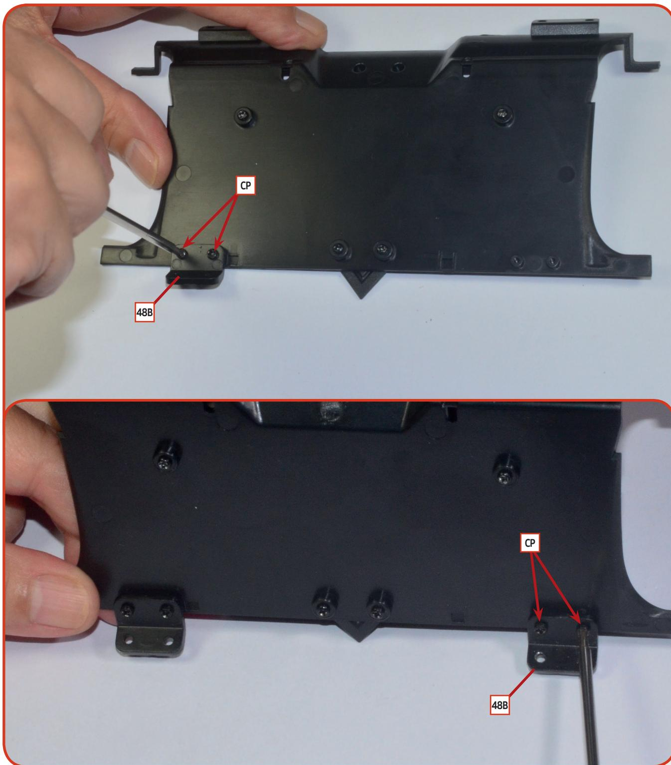
**02** Bringen Sie die beiden Halterungen **48B** in den entsprechenden Aussparungen an der Oberkante der unteren Stirnseite der Schottwand an. Vergewissern Sie sich, dass sie wie auf dem Foto gezeigt ausgerichtet sind und befestigen Sie sie mit vier Schrauben **CP** (zwei pro Halterung).
