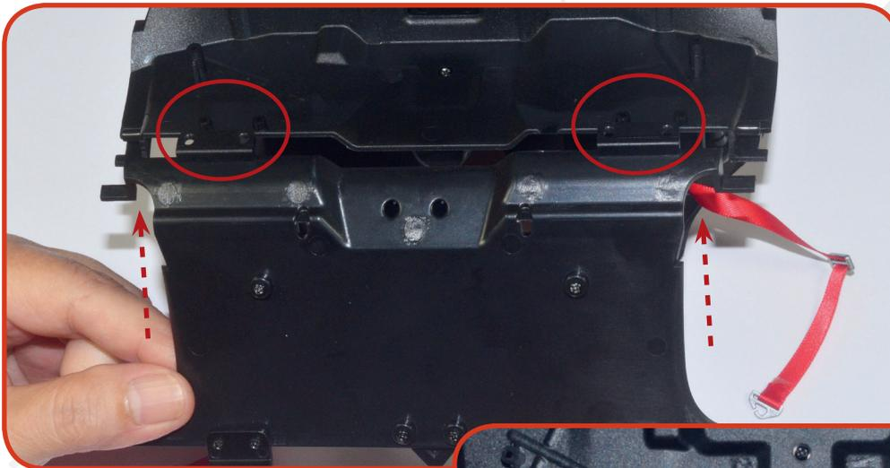
**03** Heben Sie nun den Boden des Innenraums an und setzen Sie die hintere Schottwand an der markierten Stelle ein. Richten Sie die Teile wie abgebildet aus, sodass die vier Aussparungen an der Schottwand mit den entsprechenden gebohrten Stiften an der Unterseite des Bodens übereinstimmen. Ziehen Sie vier Schrauben **CP** in den markierten Löchern fest, um die Bauteile miteinander zu verbinden.
