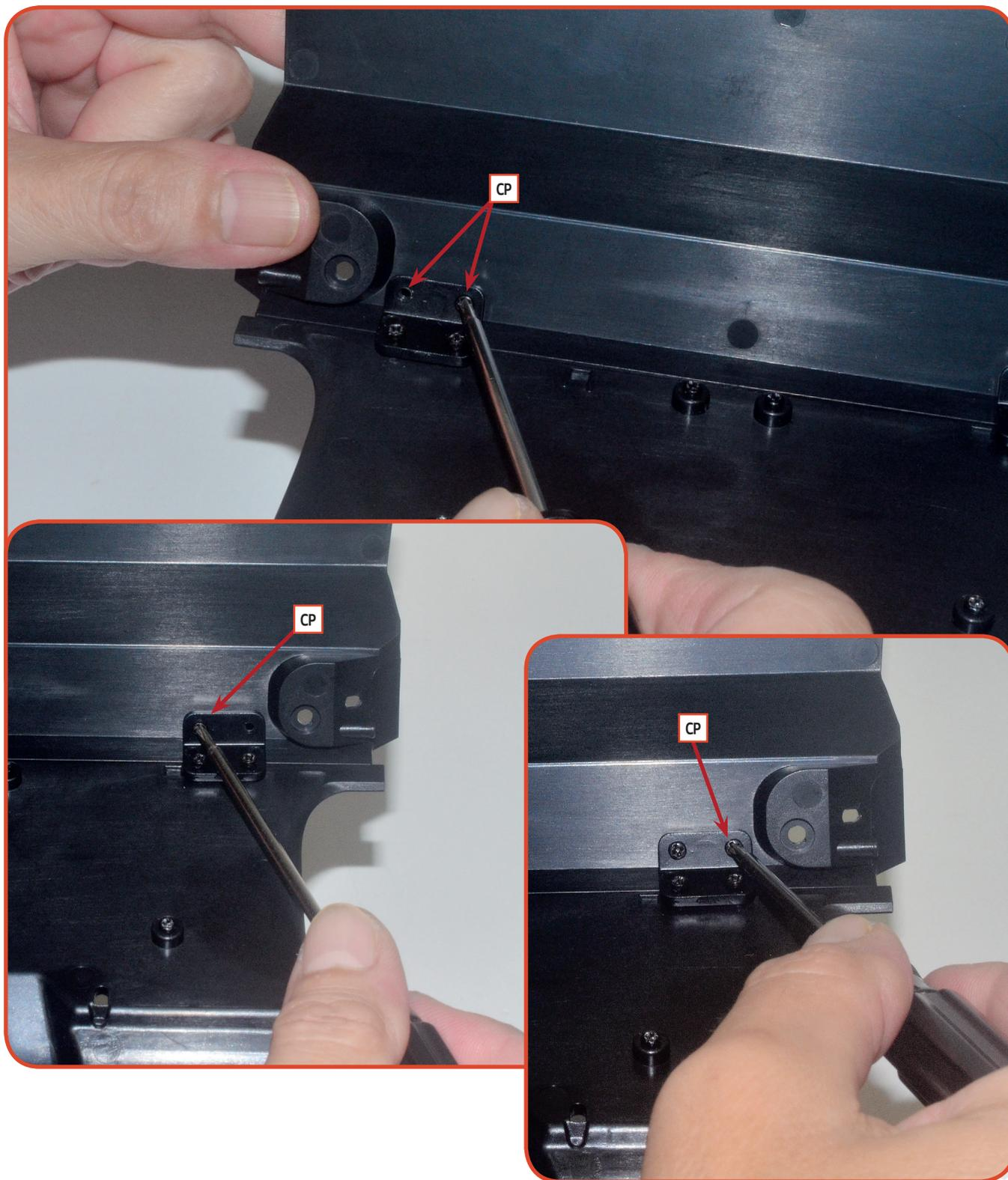
**02** Befestigen Sie die Teile miteinander, indem Sie vier Schrauben **CP** (zwei pro Halterung) in den angegebenen Löchern festziehen. Ziehen Sie die Schrauben zuerst in den beiden innersten und dann in den beiden äußersten Löchern fest, wie auf dem Foto gezeigt.
