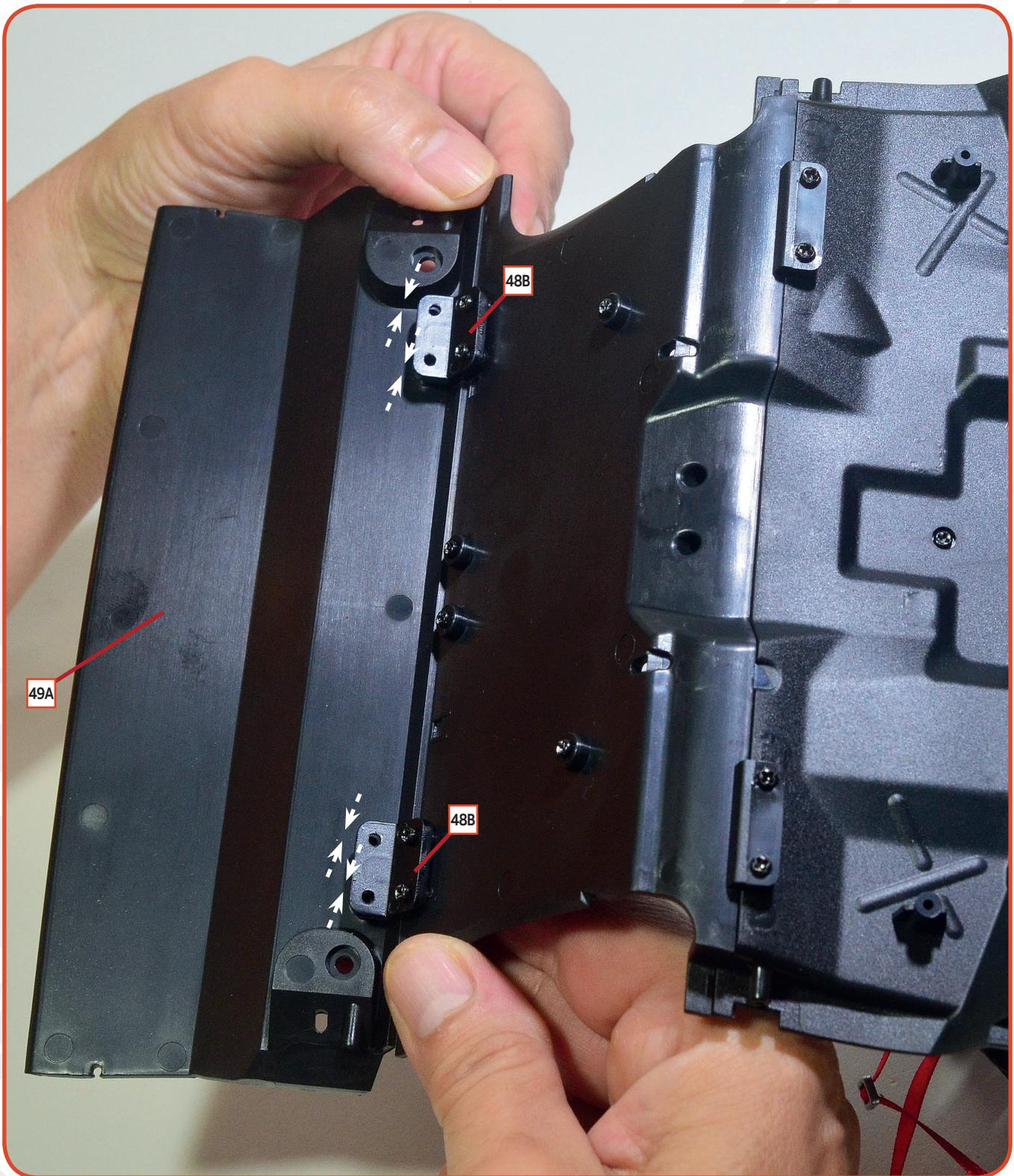
**01** Nehmen Sie die Baugruppe des Innenraumbodens zur Hand und verbinden Sie sie mit der oberen Schottwand **49A**, indem Sie die vier Löcher der Halterungen **48B** an den vorgesehenen Stellen der Unterseite der Schottwand ausrichten.
