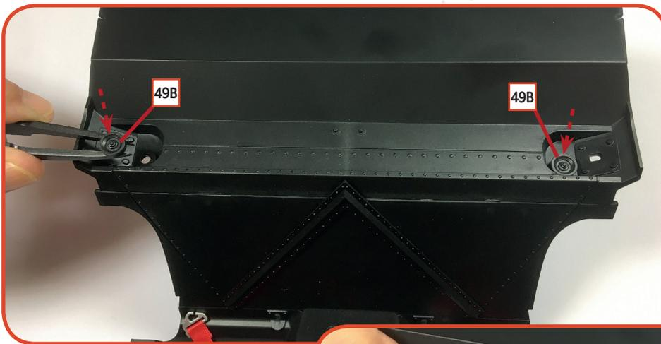
**03** Drehen Sie den Boden des Innenraums um und setzen Sie die beiden Abdeckungen **49B** in die entsprechenden Aussparungen in der oberen Schottwand ein. Die Teile werden durch leichten Druck zusammengefügt.
