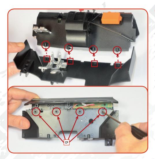
O5 Bringen Sie die Spritzwand an der Baugruppe des Armaturenbretts an, indem Sie sie wie gezeigt ausrichten und die vier Löcher der Spritzwand mit den entsprechenden gebohrten Stiften des Armaturenbretts verbinden.
