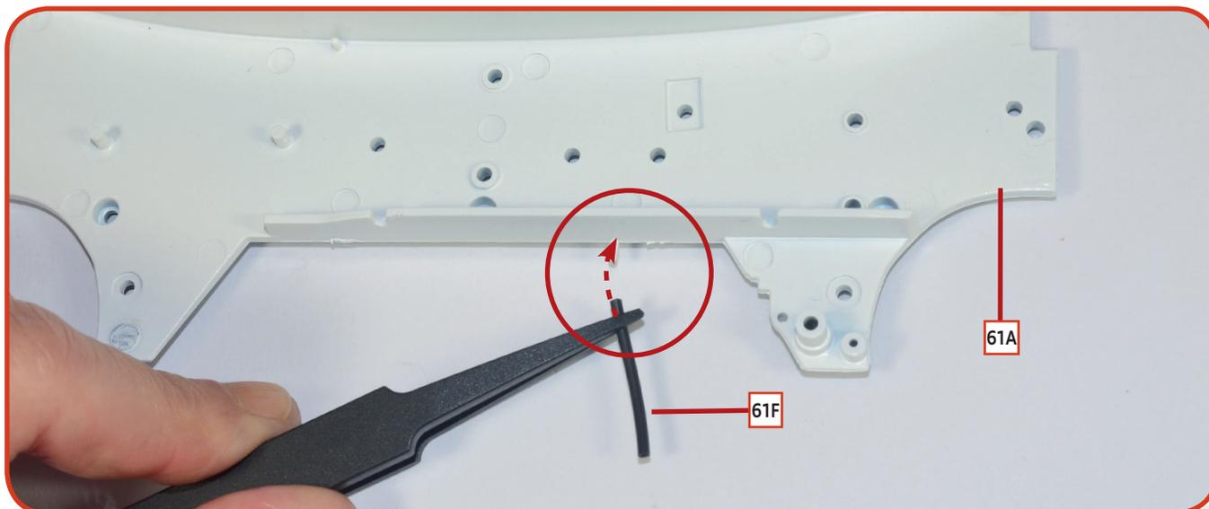
**04** Stecken Sie das kurze Rohr **61F** auf den Stift **61A** der Spritzwand, wie auf dem Foto gezeigt.
