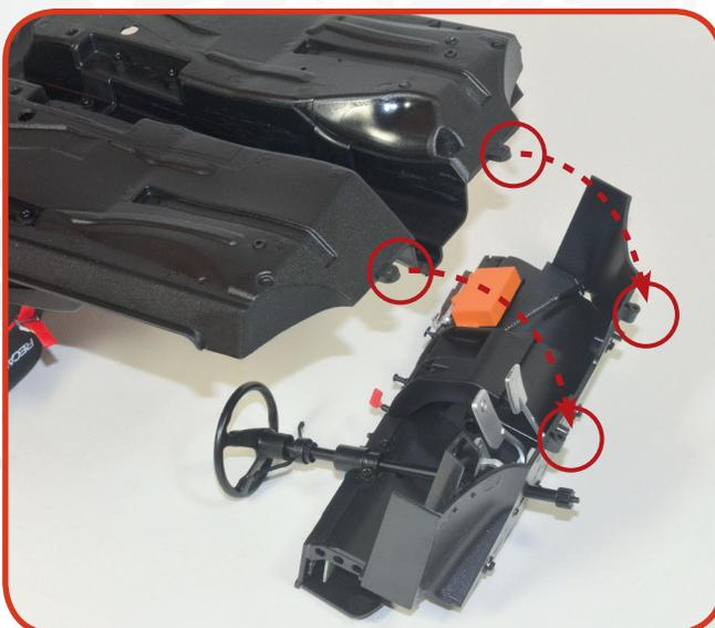
**03** Nehmen Sie jetzt den Boden des Innenraums zur Hand und verbinden Sie ihn mit der Spritzwand. Richten Sie die Teile wie abgebildet aus, stellen Sie sicher, dass die Profile gut aufeinanderpassen und befestigen Sie die Baugruppen, indem Sie zwei Schrauben **CP** in den markierten Löchern festziehen.
