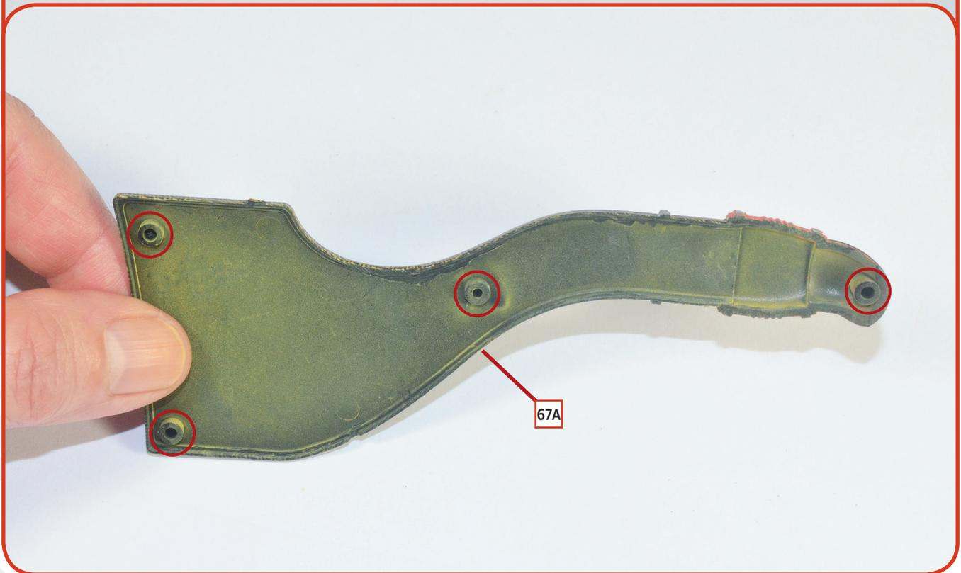
**01** Die Innenseite des Unterteils des Ansaugkrümmers **67B** hat vier Stifte. Die Innenseite des Oberteils **67A** hat dagegen vier gebohrte Zapfen, die zum Einstecken der Stifte des Unterteils dienen.
