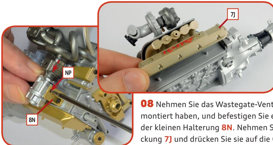
**08** Nehmen Sie das Wastegate-Ventil, das Sie in Ausgabe 8 montiert haben, und befestigen Sie es mit einer NP-Schraube an der kleinen Halterung 8N. Nehmen Sie schließlich die Abdeckung 7J und drücken Sie sie auf die Oberseite der Zylinderköpfe.
