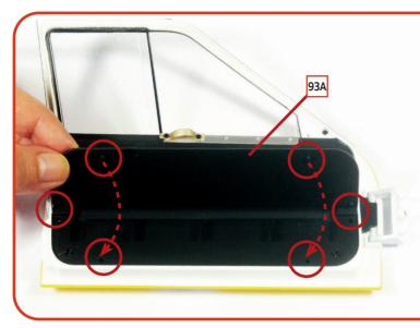
Bringen Sie die Türverkleidung **93A** an der gezeigten Stelle am unteren Teil der Türinnenverkleidung an. Setzen Sie dabei die Stifte in die entsprechenden Löcher ein und üben Sie leichten Druck auf die gesamte Oberfläche des Teils aus, um es korrekt zu befestigen.
