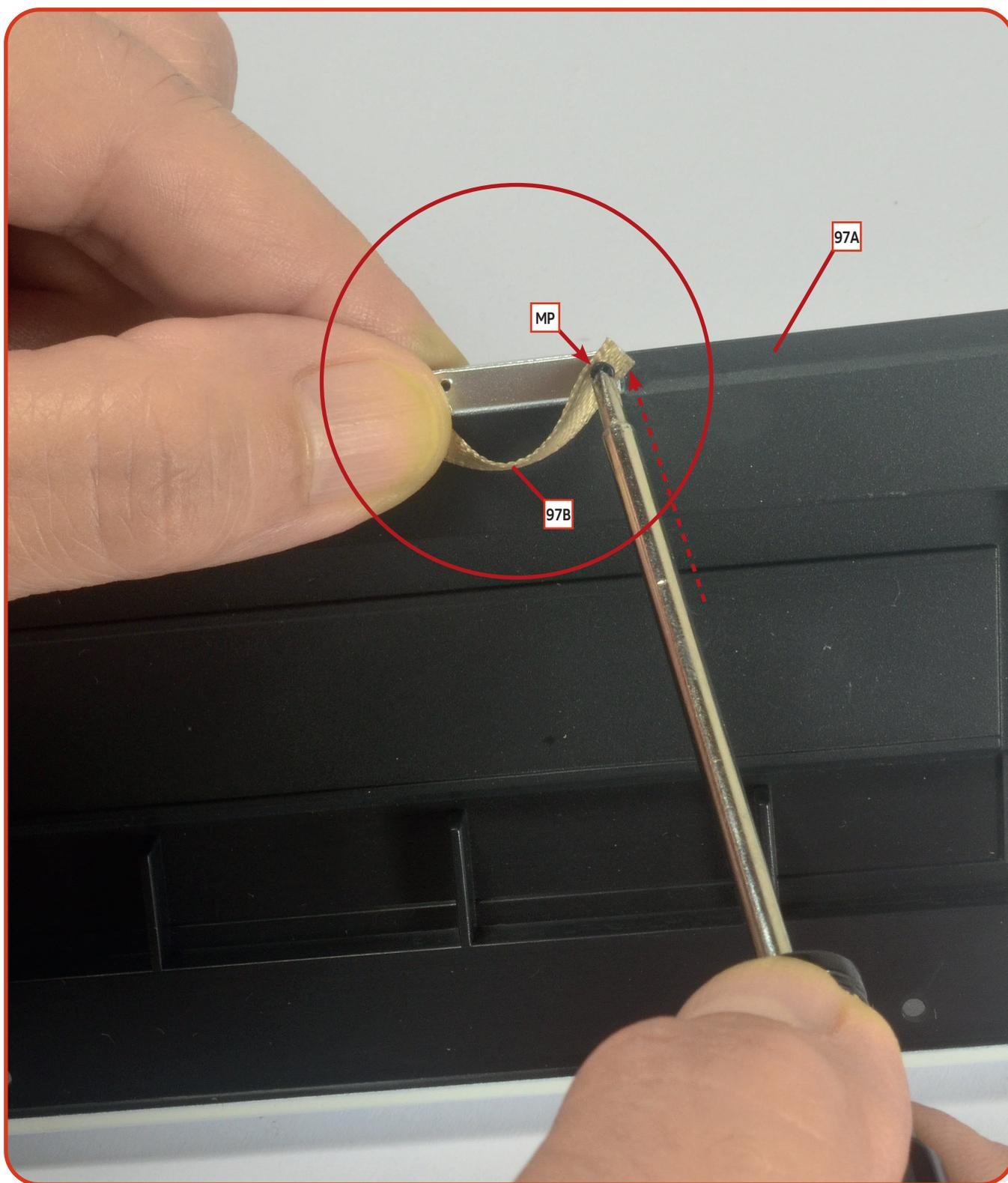
**03** Setzen Sie den Griff **97B** auf die Metalleiste der Innenplatte **97A**. Richten Sie die Schrauben an den Löchern in der Leiste aus und beginnen Sie, den Griff an der Platte zu befestigen, indem Sie eine der beiden Schrauben anziehen.
