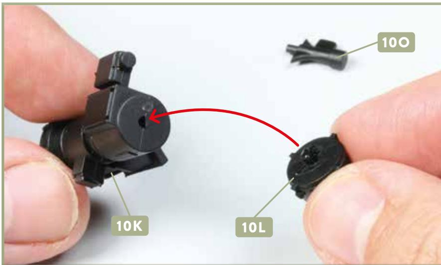
**1** Legen Sie die drei Teile für den Turbogenerator bereit: den Turbogenerator **10K**, das Bodenteil **10L** und das Vorderteil **10O**. Versehen Sie den Zapfen vom Bodenteil **10L** mit etwas Klebstoff und fügen Sie ihn in die Bohrung am Turbogenerator **10K** ein, wie angedeutet.
