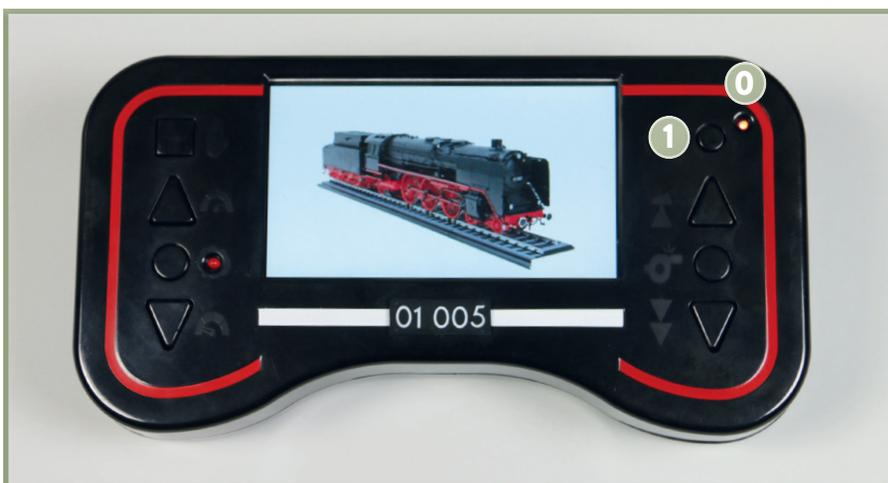
**3** Haben Sie die Fernbedienung eingeschaltet, erscheint auf dem LC-Display der Startbildschirm und die Power-LED **0** leuchtet dauerhaft (links). Nun ertönt ein „Piep“-Ton, gefolgt vom Kohlenladegeräusch. Drücken Sie auf die Kopplungstaste **1**, erscheint zunächst „PAIR...“ gefolgt von der Nachricht „CAM POWER OFF“, da die Kamera noch nicht angeschlossen ist (unten).
