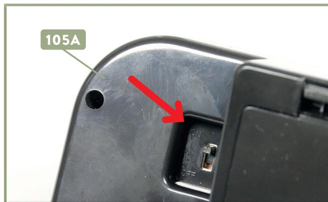
**2** Schalten Sie die Fernbedienung ein. Stellen Sie dazu den Schalter an ihrer Rückseite **105A** auf „ON“. Hinweis: Befindet sich der Hebel in Mittelstellung, ist der Stromsparmodus der Fernbedienung aktiviert. Dabei bleibt das LC-Display der Fernbedienung aus, aber Sie können sämtliche Funktionen ausführen.
