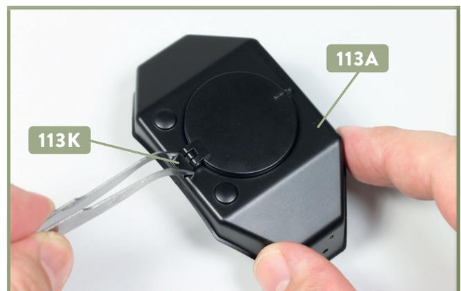
**6** Drücken Sie die beiden Zapfen des Scharniers 113K in die Aufnahmen des Sanddoms 113A hinein. Es handelt sich um eine Steckverbindung.
