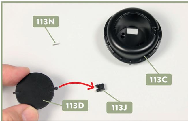
**1** Legen Sie den Dampfdom 113C, einen Deckel 113D, ein Deckelscharnier 113J und einen Scharnierstift 113N auf Ihre Arbeitsplatte. Fügen Sie den Arm vom Deckel in die Aufnahme vom Scharnier ein, wie es der Pfeil andeutet.
