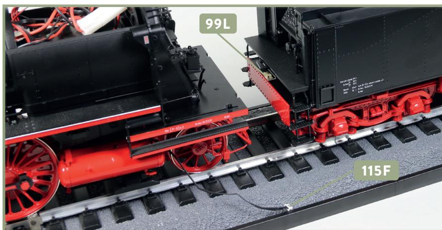
**5** Nach erfolgreichem Test der Tenderlaternen trennen Sie den Stecker vom Kabel **115F** wieder vom Port der Tender-Platine **99L**, wie abgebildet.
