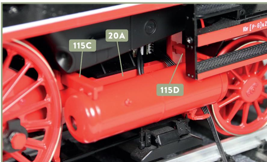
**8** Drücken Sie die Zapfen der beiden Halter 115C und 115D vorsichtig in die Aufnahmen der hinteren linken Rahmenverlängerung 20A hinein. Die Kamera ist somit am Modell befestigt und über die Platine 77D auch mit der Hauptplatine verbunden.
