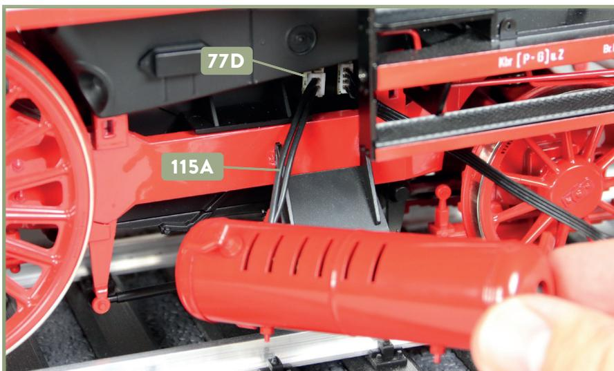
**7** Nehmen Sie den Hauptluftbehälter 115A und verbinden Sie den Stecker des daran befestigten Kamerakabels mit dem vorderen (im Foto linken) Port der Platine 77D, wie es das Foto zeigt.
