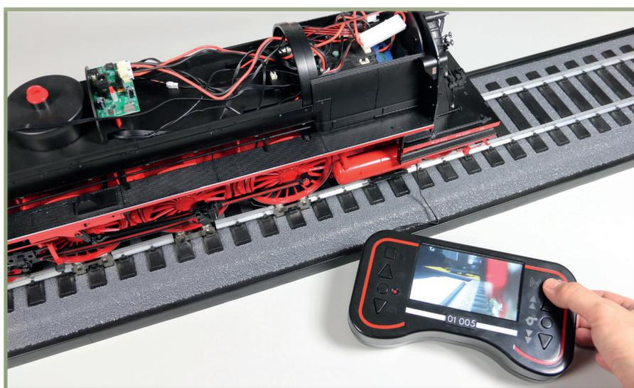
**3** Ist das Koppeln erfolgreich, erscheint auf dem Bildschirm der Fernbedienung das aktuelle Kamerabild: im rechten Bereich Teile des Fahrwerks und das Gleisbett, mittig und links die Umgebung, wie abgebildet. Nach erfolgreichem Test können Sie die Fernbedienung und die Lok ausschalten.
