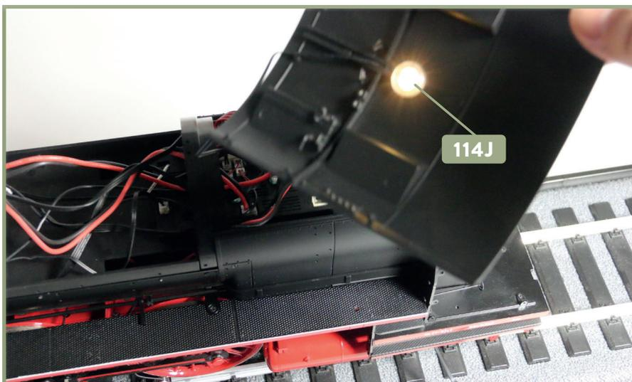
**2** Sobald Sie die Lok einschalten (blauer Pfeil im Detailbild), leuchtet die LED von **114J** auf, wie abgebildet. Trennen Sie das Kabel nach erfolgreichem Test wieder von der Hauptplatine.
