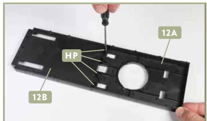
**2** Fixieren Sie die beiden Bodenteile **12A** und **12B** aneinander, indem Sie die vier Schrauben **HP** eindrehen.
