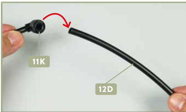
**3** Nehmen Sie die Wasserabführung **11K** und führen Sie sie zu einem Ende der Wasserleitung **12D**, wie angedeutet.
