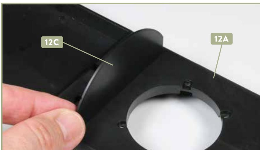
**4** Kleben Sie die Trennwand 12C in den drei Schlitzten des Bodenteils 12A fest.
