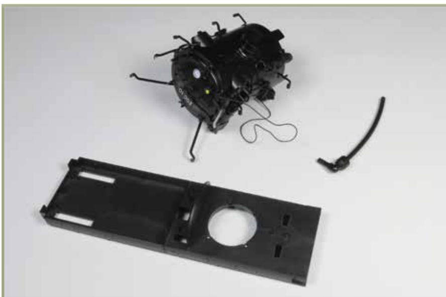
Eine Leitung wurde fixiert, eine Wasserabführung mit einer Wasserleitung verbunden. Die Arbeiten an der Bodenteil-Baugruppe haben begonnen.
