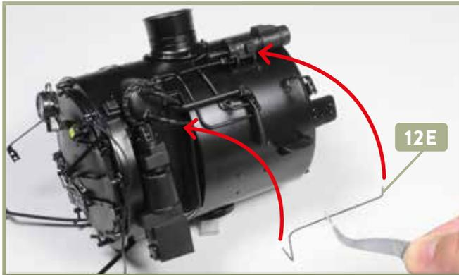
**1** Nehmen Sie die Leitung **12E**, versehen Sie deren zwei Enden mit etwas Sekundenkleber und führen Sie sie zur linken Seite der Rauchkammer, wie es die beiden Pfeile andeuten.
