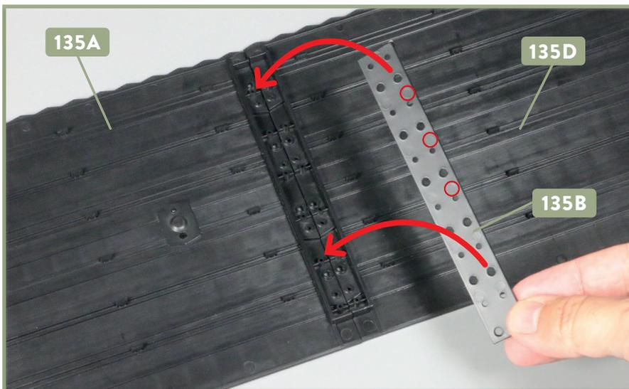
**2** Die beiden Dachabschnitte **135A** und **135D** liegen bündig aneinander. Platzieren Sie die Kupplungsleiste **135B** so, dass sie auf beiden Abschnitten aufliegt, wie es die Pfeile andeuten. Die Seite der Leiste, auf der sich runde Auswurfmarken befinden (drei sind exemplarisch eingekreist), soll nicht sichtbar sein.
