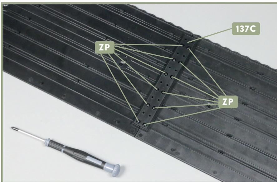
**4** Fixieren Sie die Kupplungsleiste 137C mit den zwölf Schrauben ZP an den beiden Dachabschnitten.
