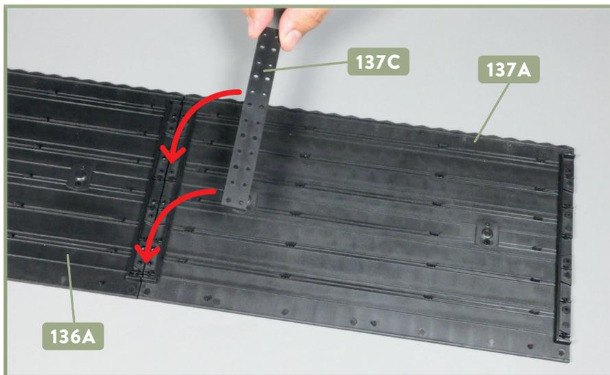
**2** Die beiden Dachabschnitte **136A** und **137A** liegen bündig aneinander. Platzieren Sie die Kupplungsleiste **137C** so, dass sie auf beiden Abschnitten aufliegt, wie es die Pfeile andeuten. Die Seite der Leiste mit den runden Auswurfmarken soll nicht sichtbar sein.
