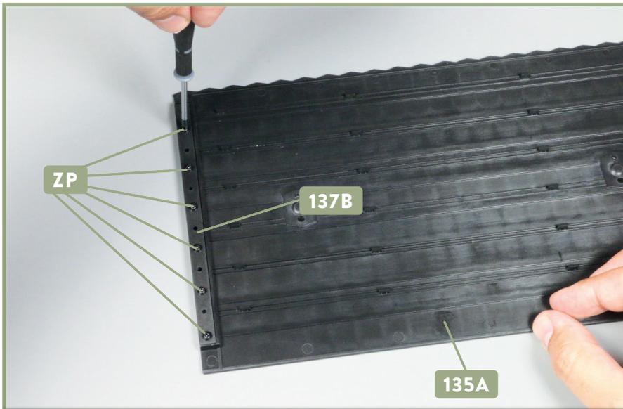
**7** Am anderen Ende des Dachs wird auf dem Rand des Dachabschnitts **135A** die andere Endleiste **137B** aufgesetzt und ebenfalls mit sechs Schrauben **ZP** fixiert.
