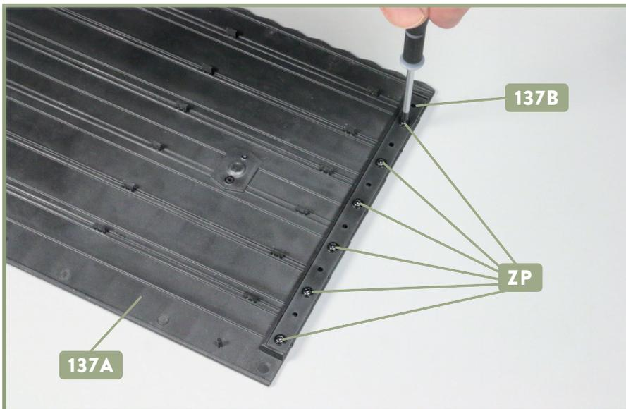
**6** Befestigen Sie die Endleiste 137B am Dachabschnitt 137A, indem Sie die sechs Schrauben ZP eindrehen.
