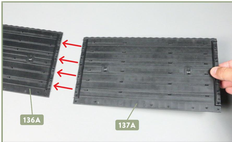
**1** Legen Sie die Dach-Baugruppe mit der Unterseite nach oben so auf Ihre Arbeitsplatte, dass Sie Zugriff auf den Abschnitt **136A** haben. Nehmen Sie den Dachabschnitt **137A** und platzieren Sie ihn neben dem Dachabschnitt **136A**: Die Innenkanten sollen direkt aneinander liegen, wie es die Pfeile andeuten.
