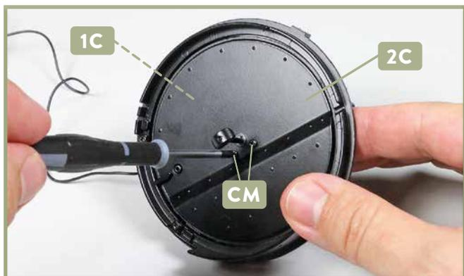
**7** Befestigen Sie die Rückwand **2C** an der Rauchkammertür **1C**. Drehen Sie dazu zwei Schrauben **CM** von der Rückseite in die Bohrungen der Rückwand hinein. Schließen Sie die Rauchkammertür.
