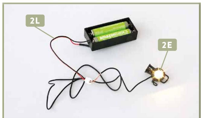
**2** Verbinden Sie den Stecker vom Kabel der Loklaterne **2E** mit der Buchse vom Kabel der Batteriebox **2L**: Die LED-Laterne leuchtet auf. Trennen Sie die beiden Kabel nach dem Test wieder voneinander.
