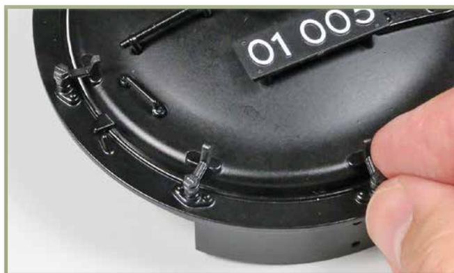
**8** Drehen Sie die Baugruppe um und verriegeln Sie die Rauchkammertür, indem Sie die acht Vorreiber wieder zurückdrehen, wie es das Foto zeigt.
