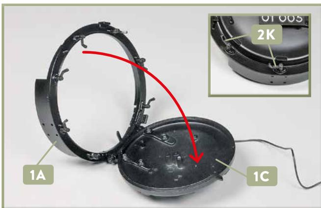
**1** Drehen Sie die acht Vorreiber **2K** an der Türwand **1A** zur Seite und öffnen Sie die Rauchkammertür **1C**, wie abgebildet.
