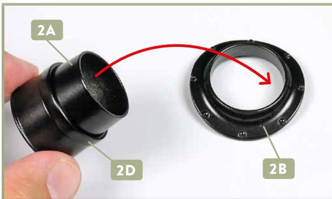
**3** Der Schornsteinring **2D** ist korrekt am Schornsteinaufsatz **2A** angebracht. Versehen Sie die Kontaktstellen mit etwas Sekundenkleber und fügen Sie die Baugruppe von oben in den Schornsteinfuß **2B** ein, wie durch den Pfeil angedeutet.
