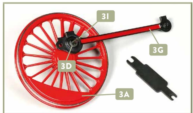
**6** Die Kuppelstange **3G** ist am Zapfen **3I** aufgesetzt. Fixiert wird die Stange, indem Sie mit dem Aufsteckschlüssel einen weiteren C-Ring **3D** in der nächsten Vertiefung des Zapfens anbringen.
