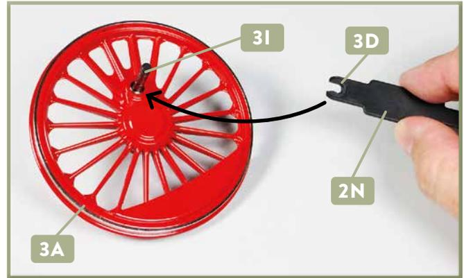
**2** Der Zapfen **3I** ist in die Bohrung des Rads **3A** eingefügt. Platzieren Sie einen der C-Ringe **3D** in der Vertiefung am breiteren Ende des Aufsteckschlüssels **2N**. Führen Sie den C-Ring zum Zapfen, wie es der Pfeil andeutet.
