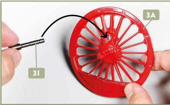
**1** Nehmen Sie einen der beiden Kuppelzapfen **3I** und führen Sie ihn zur Bohrung des hinteren Kuppelrads **3A**, wie angedeutet.
