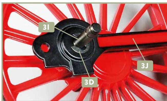
**8** Befestigen Sie die Kuppelstange **3J** am Rad, indem Sie sie am Kuppelzapfen **3I** aufsetzen und den C-Ring **3D** in der Vertiefung des Zapfens anbringen.
