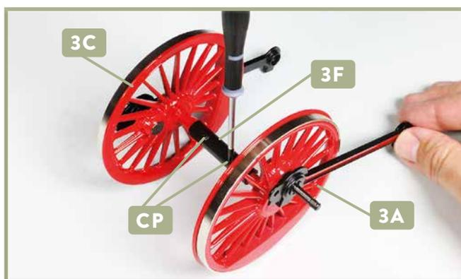
**10** Befestigen Sie die beiden Räder **3A** und **3C** an der Achse **3F**, indem Sie in deren Bohrungen zwei Schrauben **CP** eindrehen.
