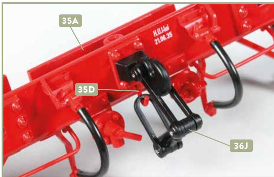
**13** Die Schraubenkupplung **36J** ist am Pufferträger **35A** festgeklebt. Der Schäkel der Kupplung ist in die Halterung **35D** eingehängt, wie abgebildet.
