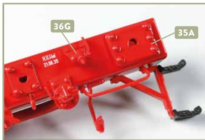
**8** Auf die gleiche Weise werden die beiden Zapfen an der Rückseite des Luftabsperrentils **36G** mit Sekundenkleber versehen und am Pufferträger **35A** fixiert.
