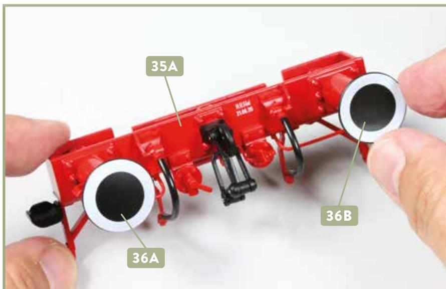
**15** Der rechte (konvexe) Puffer **36A** ist am rechten Ende des Pufferträgers **35A** fixiert. Am anderen Ende wird der linke (konkave) Puffer **36B** festgeklebt.
