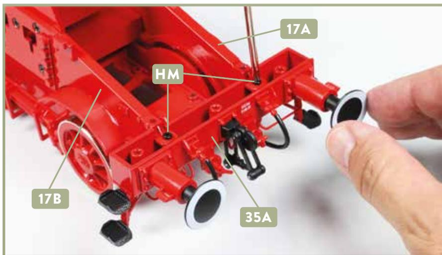
**2** Befestigen Sie den Pufferträger **35A** mit je einer Schraube **HM** an den beiden Rahmenverlängerungen **17A** und **17B**.
