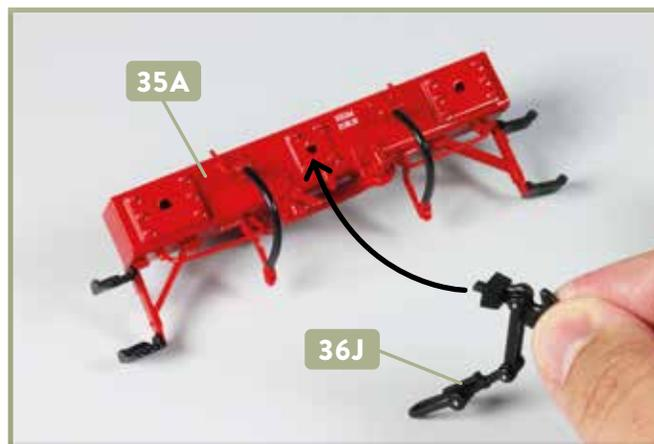
**12** Nehmen Sie die Schraubenkupplung **36J**, versehen Sie deren breiten Zapfen mit etwas Sekundenkleber und fügen Sie diesen in die zentrale Bohrung des Pufferträgers **35A** ein, auf die der Pfeil weist.
