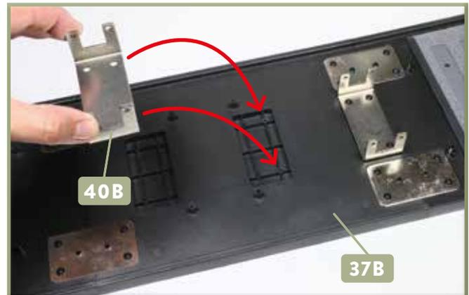
**4** Nehmen Sie die zweite Schienenrollen-Halterung **40B** und platzieren Sie deren Bohrungen auf den Aufnahmen der Bodenplatte **37B**, auf die die Pfeile weisen.
