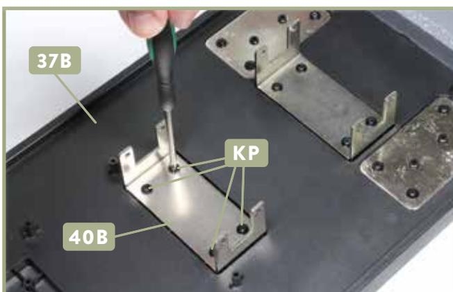
**5** Fixieren Sie die Schienenrollen-Halterung **40B** mit vier Schrauben **KP** an der Bodenplatte **37B**.
