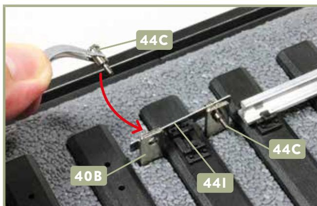
**2** Setzen Sie die beiden Sicherungstifte **44C** von außen in die Bohrungen der Rollenhalterung **44I** und der Schienenrollen-Halterung **40B** ein, wie abgebildet.
