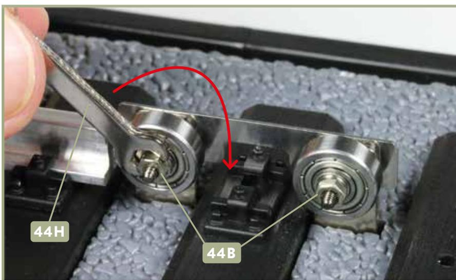
**12** Setzen Sie auf die beiden Sicherungstifte je eine Mutter **44B** und ziehen Sie diese mit dem Schraubenschlüssel **44H** fest, wie abgebildet.
