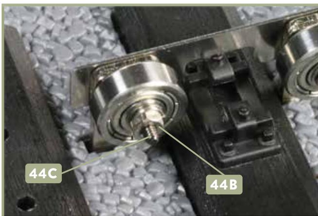
**7** Nehmen Sie eine Mutter **44B** und setzen Sie sie auf den einen Sicherungsstift **44C**.
