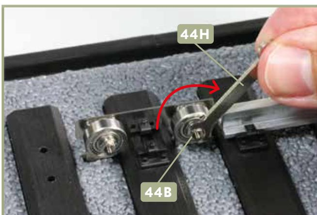
**9** Die nächste Mutter **44B** wird auf den anderen Sicherungsstift gesetzt und mithilfe des Schraubenschlüssels **44H** festgezogen.
