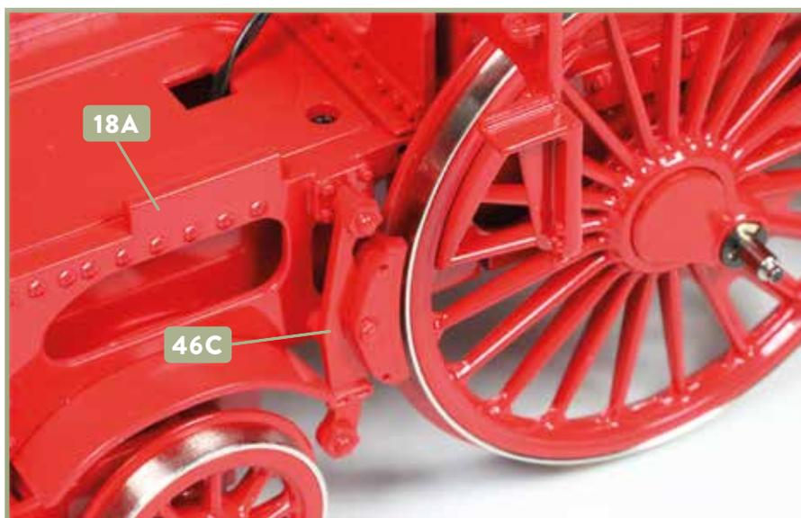
**12** Das Bremsgestänge **46C** ist an der linken Rahmenwange **18A** festgeklebt.
