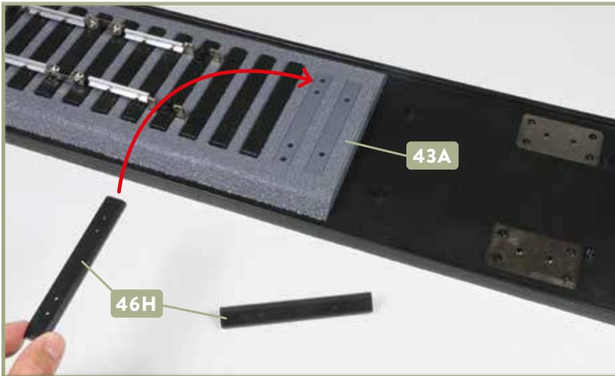
**1** Legen Sie das Gleisbett und die beiden Schwellen **46H** auf Ihre Arbeitsplatte. Nehmen Sie die erste Schwelle und führen Sie sie zu der Vertiefung in der Bettung **43A**, auf die der Pfeil weist.
