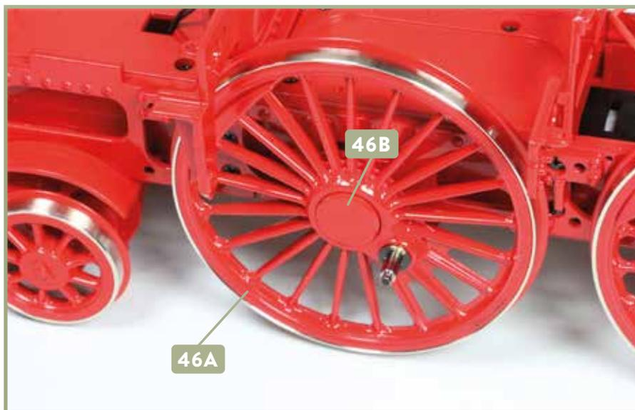
**10** Der Nabendeckel **46B** ist am Treibrad **46A** festgeklebt.
