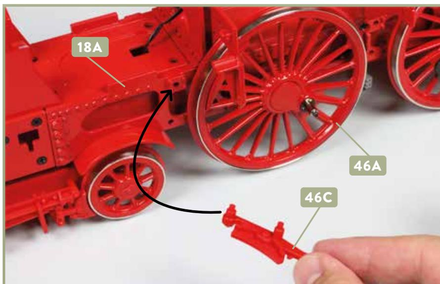
**11** Nehmen Sie das Bremsgestänge **46C** und versehen Sie dessen zwei Zapfen mit etwas Sekundenkleber. Führen Sie das Teil zu den beiden Bohrungen, die sich direkt vor dem Treibrad **46A** in der linken Rahmenwange **18A** befinden.
