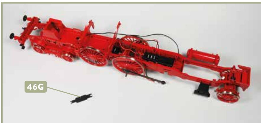
Das linke Treibrad ist mit einem Kuppelzapfen versehen und an der Welle des vorderen Antriebsgetriebes befestigt.
