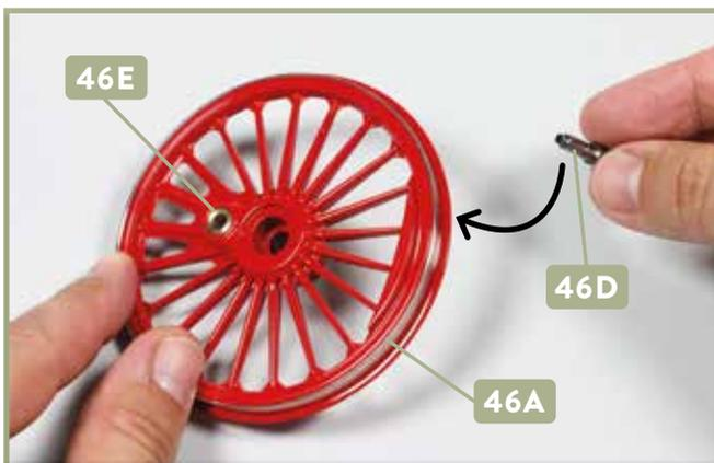
**3** Die Buchse **46E** sitzt in der Bohrung des Treibrads **46A**. Führen Sie den Kuppelzapfen **46D** von hinten zur Buchse, wie es der Pfeil andeutet.
