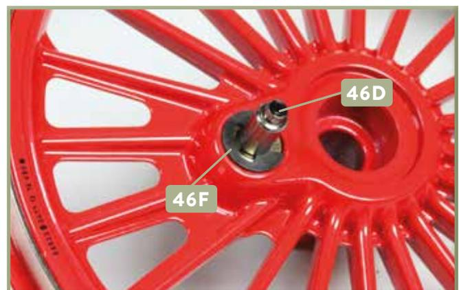
**6** Der C-Ring **46F** sitzt in der Vertiefung des Kuppelzapfens **46D** und hält diesen in Position.
