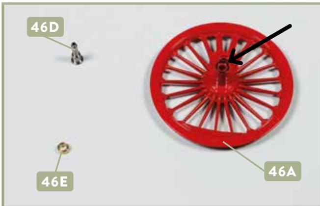
**1** Legen Sie das linke Treibrad **46A**, den Kuppelzapfen **46D** und die Buchse **46E** bereit. Das Treibrad unterscheidet sich von seinem rechten Gegenstück, das Sie mit Ausgabe 47 erhalten werden, durch den schwarzen Kreis an der Nabe (Pfeil).
