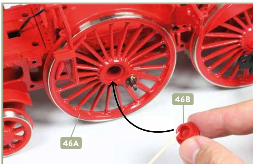
**9** Nehmen Sie den Nabendeckel **46B**, versehen Sie seine Innenseite mit etwas Sekundenkleber und führen Sie ihn zur zentralen Bohrung des Treibrads **46A**.
