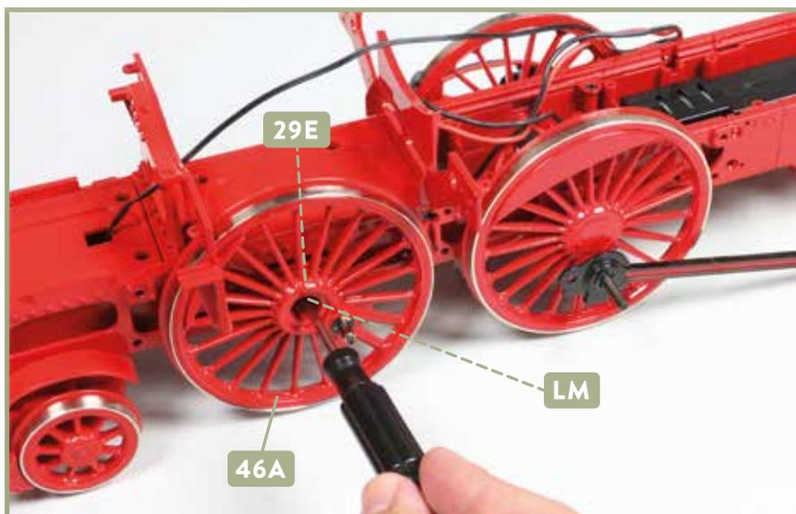
**8** Sitzt das Treibrad **46A** korrekt auf dem linken Ende der Welle **29E**, wird es mit einer Schraube **LM** befestigt.
