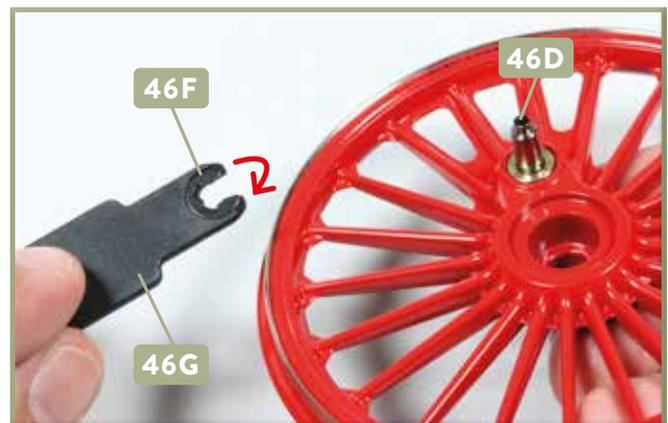
**4** Der Kuppelzapfen **46D** ist korrekt platziert. Setzen Sie einen der C-Ringe **46F** in die Vertiefung am breiteren Ende des Aufsteckschlüssels **46G**. Drehen Sie den Schlüssel anschließend um.
