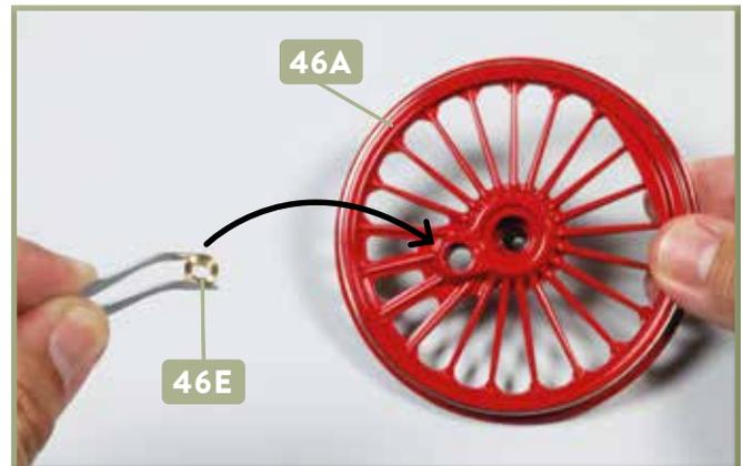
**2** Nehmen Sie die Buchse **46E** und setzen Sie sie in die Bohrung des Treibrads **46A** ein, auf die der Pfeil weist.
