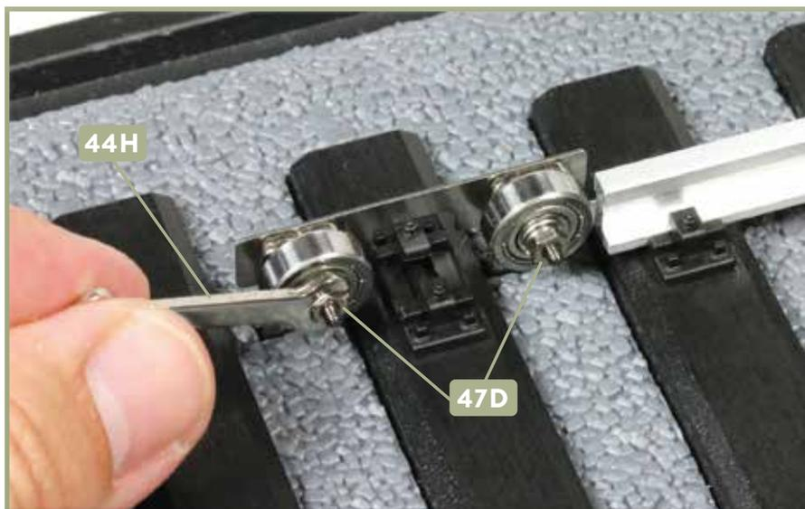
**9** Setzen Sie als Letztes auf die beiden Sicherungstifte je eine Mutter **47D** und ziehen Sie diese mit dem Schraubenschlüssel **44H** fest, wie abgebildet.
