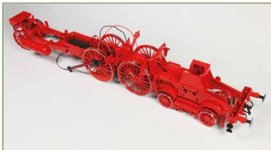
Das rechte Treibrad ist mit einem Kuppelzapfen versehen und an der Welle des vorderen Antriebsgetriebes befestigt.
