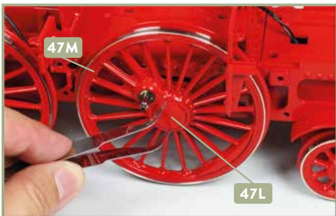
**7** Kleben Sie den Nabendeckel **47L** in der zentralen Bohrung des Treibrads **47M** fest.
