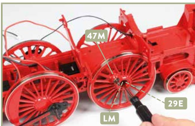
**5** Sitzt das rechte Treibrad 47M korrekt auf dem abgeflachten Ende der Welle 29E, wird es mit einer Schraube LM befestigt.
