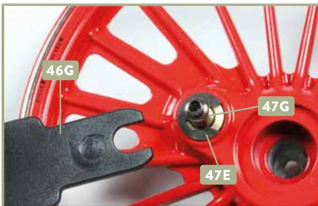
**3** Setzen Sie den C-Ring 47E in die Vertiefung am breiteren Ende des Aufsteckschlüssels 46G. Drehen Sie den Schlüssel um und bringen Sie den C-Ring in der Vertiefung des Kuppelzapfens 47G an.
