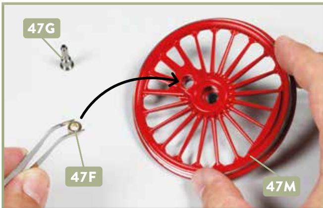
**1** Legen Sie die Buchse 47E, den Kuppelzapfen 47G und das rechte Treibrad 47M bereit. Nehmen Sie die Buchse und setzen Sie sie in die Bohrung des Treibrads ein, auf die der Pfeil weist.
