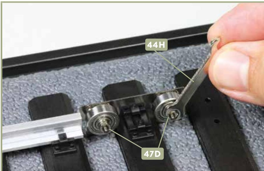
**6** Nehmen Sie zwei Muttern **47D** und befestigen Sie mithilfe des Schraubenschlüssels **44H** je eine von ihnen auf den beiden Sicherungsstiften.
