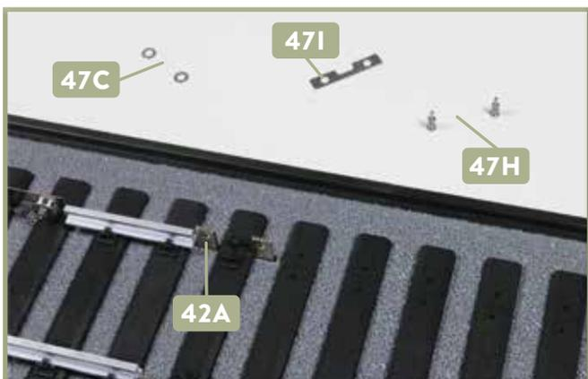
**1** Legen Sie das Gleisbett bereit. Positionieren Sie zwei große Laufringe **47C**, zwei Sicherungstifte **47H** und eine Rollenhalterung **47I** neben der Schienenrollen-Halterung **42A**.
