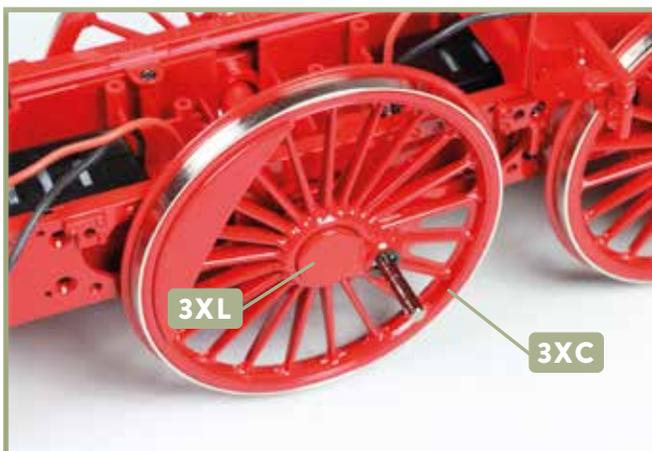
**11** Wechsel auf die rechte Fahrwerksseite: Drücken Sie einen der beiden Nabendeckel **3XL** in die zentrale Bohrung des Kuppelrads **3XC** hinein, wie abgebildet. Kleben Sie den Nabendeckel nicht fest!
