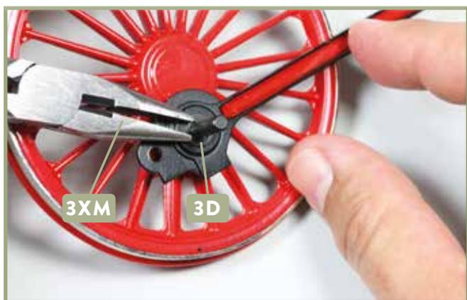
**3** Nun werden die beiden Kuppelräder aus der Ausgabe 3 wieder auseinanderggebaut. Zum Lösen der C-Ringe **3D** nehmen Sie die Spitzzange **3XM** zu Hilfe. (Sehen Sie sich für die einzelnen Bauschritte ggf. auch die Bauanleitung von Ausgabe 3 an.)
