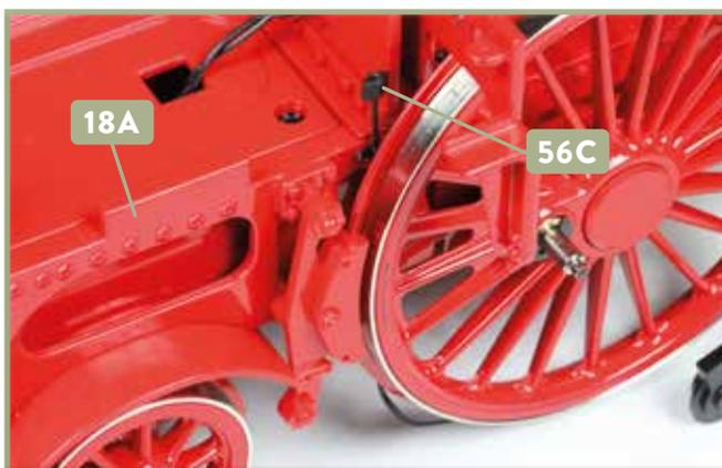
**2** Die beiden Zapfen des Sandfallrohrs **56C** sind in den zwei Bohrungen der linken Rahmenwange **18A** festgeklebt.
