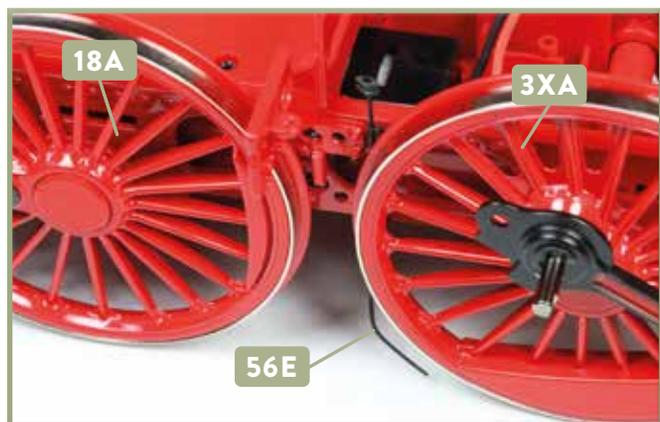
**3** Das Sandfallrohr **56E** wird in den zwei Bohrungen der linken Rahmenwange **18A** festgeklebt, die sich direkt vor dem linken Kuppelrad **3XA** befinden.
