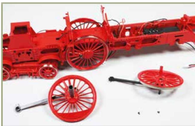
**2** Sobald die beiden Schrauben gelöst sind, können Sie die beiden Kuppelräder vom Fahrwerk entfernen, wie abgebildet.
