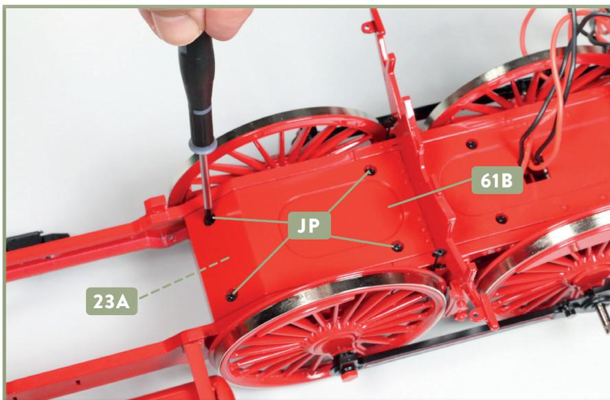
**2** Befestigen Sie die Abdeckung **61B** an der Innenpartie des Rahmens **23A**, indem Sie vier Schrauben **JP** eindrehen.
