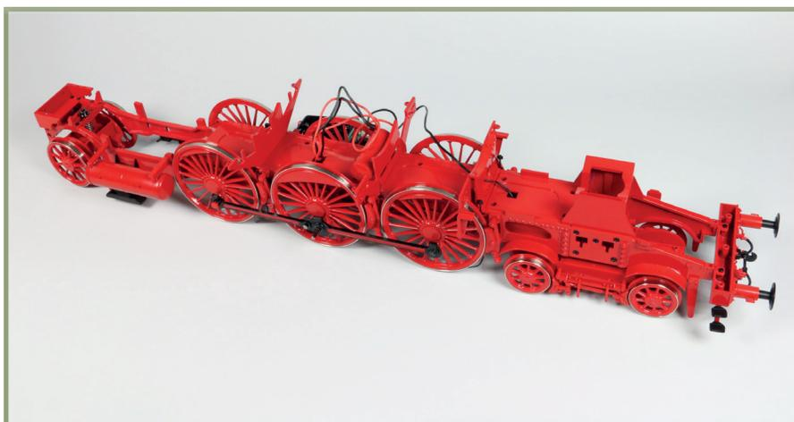
Eine weitere Abdeckung und der rechte Indusi-Magnet sind am Rahmen montiert. Am Gleisbett sind weitere Schwellen und Klein-eisen angebracht (nicht abgebildet).
