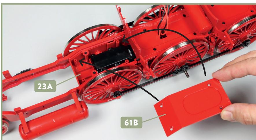
**1** Platzieren Sie das Fahrgestell auf Ihrer Arbeitsplatte. Nehmen Sie die Abdeckung 61B und setzen Sie diese auf das hintere Ende der Innenpartie des Rahmens 23A.
