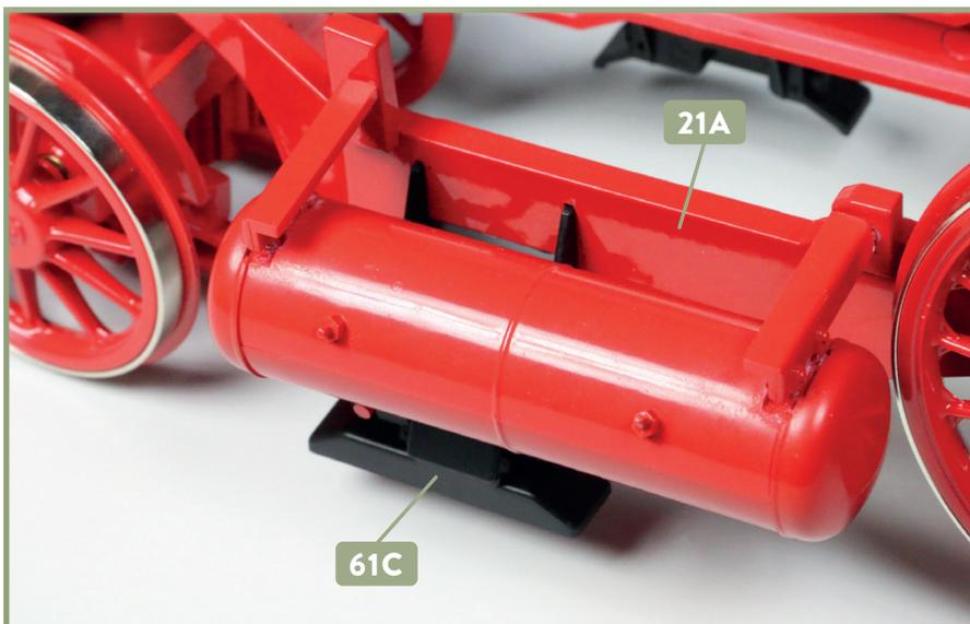
**3** Nehmen Sie den Indusi-Magneten **61C**, versehen Sie dessen zwei Zapfen mit etwas Sekundenkleber und fügen Sie diese in die beiden Schlitz an der hinteren rechten Rahmenverlängerung **21A** ein.
