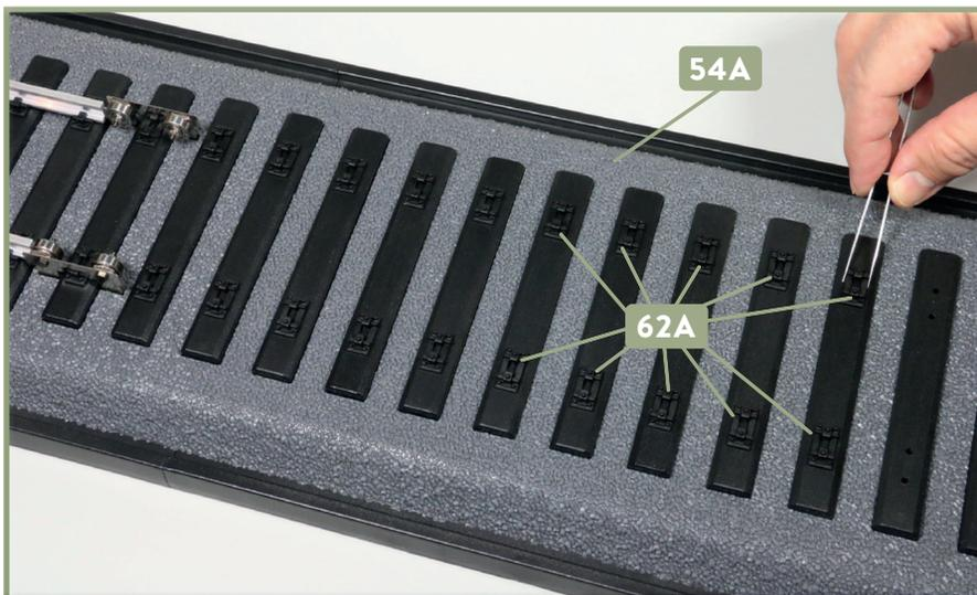
**2** Fixieren Sie die zehn Kleiseisen **62A** an den nächsten freien Schwellen des Bettungsabschnitts **54A**. Versehen Sie zuvor die Zapfen der Kleiseisen jeweils mit etwas Sekundenkleber.
