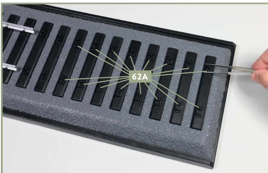
**6** Die übrigen 16 Kleiseisen **62A** werden an den acht letzten Schwellen des Gleisbetts festgeklebt, wie abgebildet.
