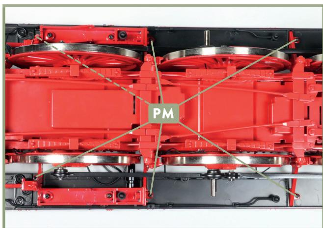
**9** Drehen Sie das Modell vorsichtig um und fixieren Sie die beiden Baugruppen aneinander, indem Sie sechs Schrauben **PM** durch die seitlichen Bohrungen der Rauchkammerstütze bzw. der beiden Pendelbleche in die Aufnahmen des Umlaufblechs hineindrehen.
