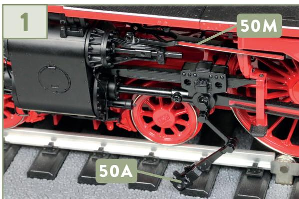
Lösen Sie die Schraubbolzen (**68G** und **68H**, siehe Foto oben), sodass die Schieberstange **50A** und der Voreilhebel **50M** beiseite geschoben werden können, wie abgebildet.
