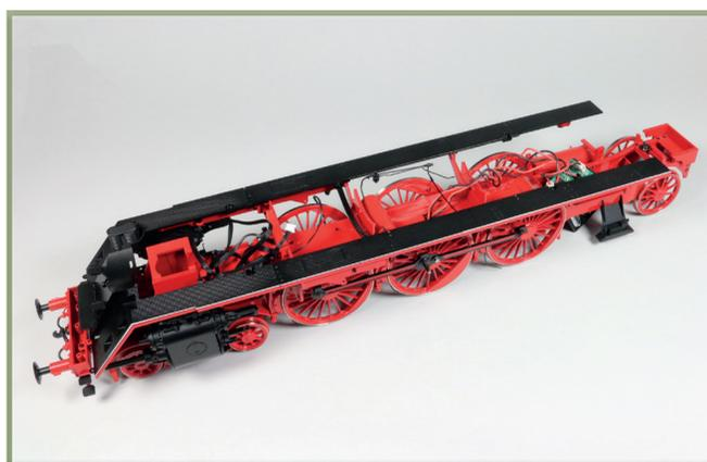
**8** Drehen Sie die Umlaufblech-Baugruppe um und setzen Sie sie auf den Rahmen, wie abgebildet.
