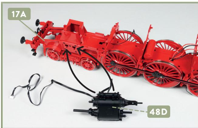
**1** Legen Sie den linken Zylinderblock vor die linke Seite des Lokrahmens. Die Bügel des linken Dampfzuegers **48D** werden in die Öffnungen der Rahmenverlängerung **17A** eingefügt, wie es die beiden Pfeile andeuten.
