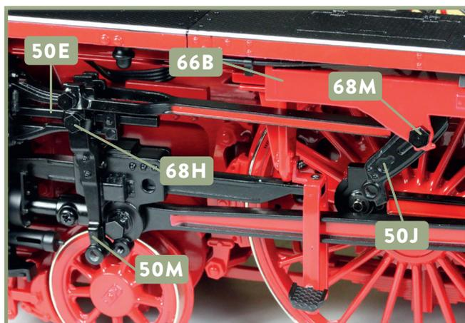
**12** Führen Sie den Schraubbolzen **68H** durch die Bohrungen von Voreilhebel **50M** und Schieberstange **50E** und drehen Sie ihn mithilfe des Schraubenschlüssels fest. Der Schraubbolzen **68M** sichert die Schwinge **50J** am Schwingenträger **66B**.
