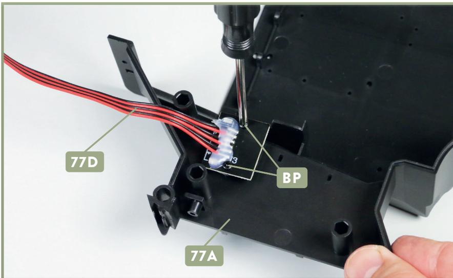
**2** Befestigen Sie die Platine **77D** mit zwei Schrauben **BP** an der Seitenwand **77A**.
