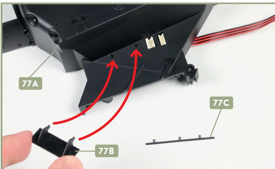
**3** Legen Sie die Leiste **77C** bereit. Nehmen Sie die Luftführung **77B**, versehen Sie deren zwei Zapfen mit etwas Sekundenkleber und führen Sie sie zu den beiden rechteckigen Öffnungen im unteren Bereich der Seitenwand **77A**, wie angedeutet.
