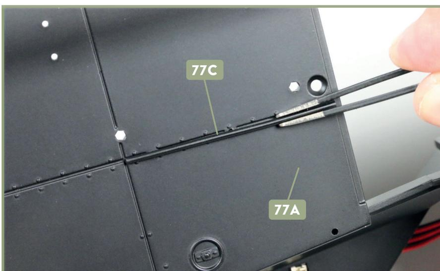
**5** Geben Sie etwas Sekundenkleber auf die drei Zapfen an der Innenseite der Leiste **77C** und fügen Sie diese in die Bohrungen der Seitenwand **77A** ein.
