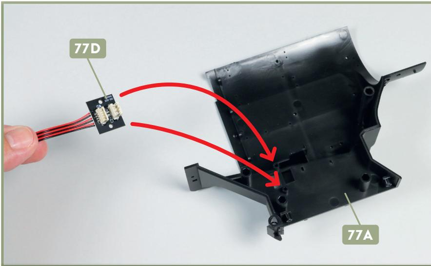
**1** Legen Sie die Seitenwand **77A** mit der Innenseite nach oben auf Ihre Arbeitsplatte. Nehmen Sie die Platine **77D** und platzieren Sie sie auf den beiden Aufnahmen an der Seitenwand, wie es die Pfeile andeuten.
