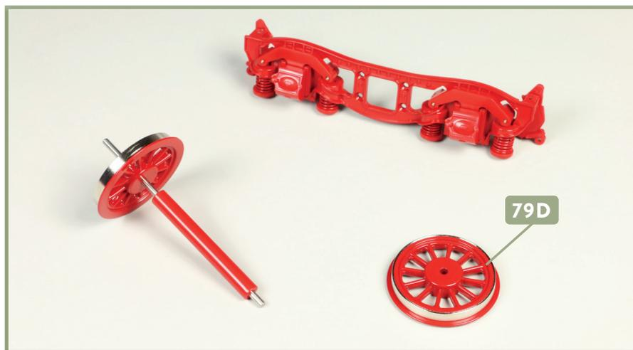
Am linken Drehgestellrahmen sind Bremsklötze, Spiralfedern und Achslagerdeckel angebracht. Die Welle wurde für den Einbau in den Rahmen vorbereitet. Dieser erfolgt in der Ausgabe 82 – dann wird auch das zweite Rad **79D** benötigt.
