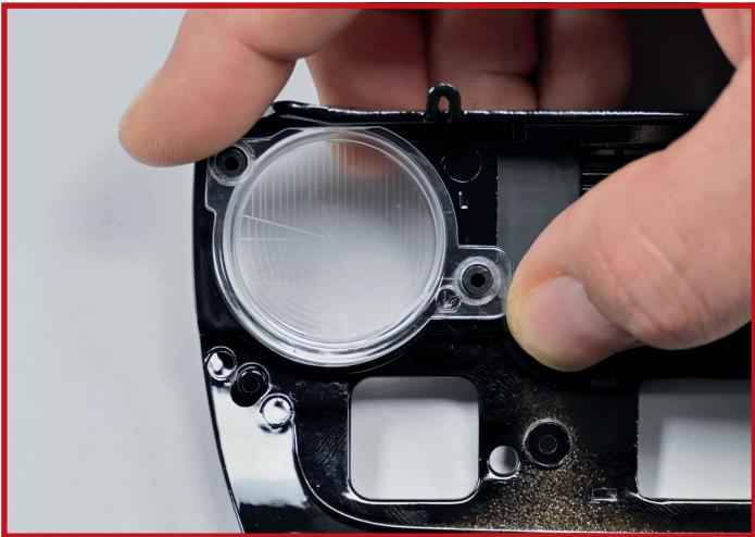
**7** Setzen Sie das linke Scheinwerferglas **1H** von innen in die Frontmaske **1A** ein und richten Sie die Löcher an den entsprechenden Bohrstiften aus.
