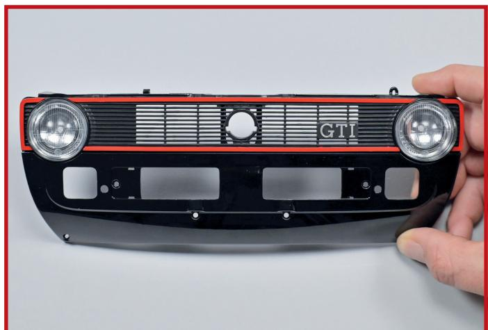
**11** Drehen Sie die Frontmaske um. In der Mitte des Kühlergrills **1B** befindet sich ein rundes Loch mit zwei Nuten, in dem das Volkswagen-Emblem angebracht wird.
