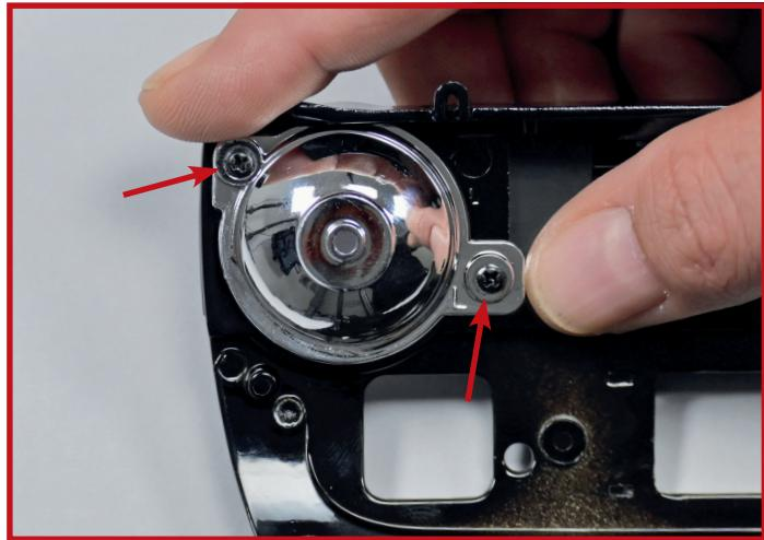
**8** Setzen Sie das linke Scheinwerfergehäuse **1G** auf das Scheinwerferglas. Befestigen Sie das Gehäuse mit zwei Schrauben **PS25**.
