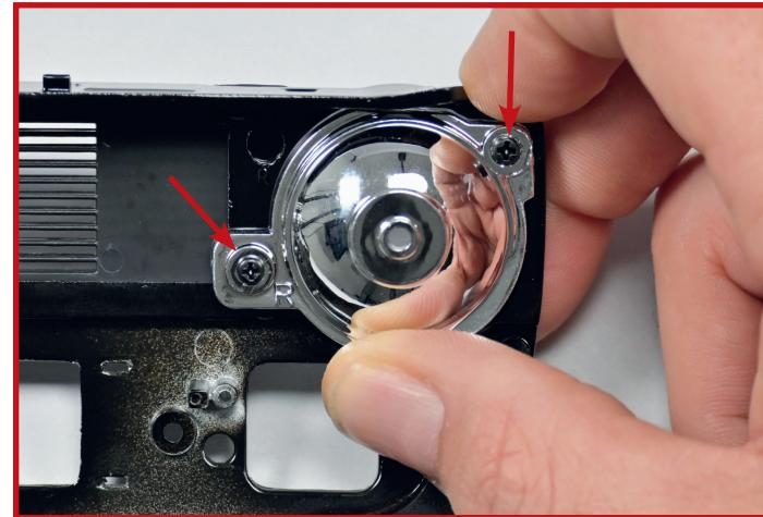
**10** Platzieren Sie das rechte Scheinwerfergehäuse **1D** auf dem Scheinwerferglas. Befestigen Sie das Gehäuse mit zwei Schrauben **PS25**.
