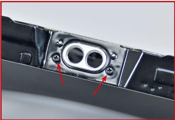
**3** Befestigen Sie das Motorhaubenschloss mit zwei Schrauben **PS12** an der Frontmaske.
