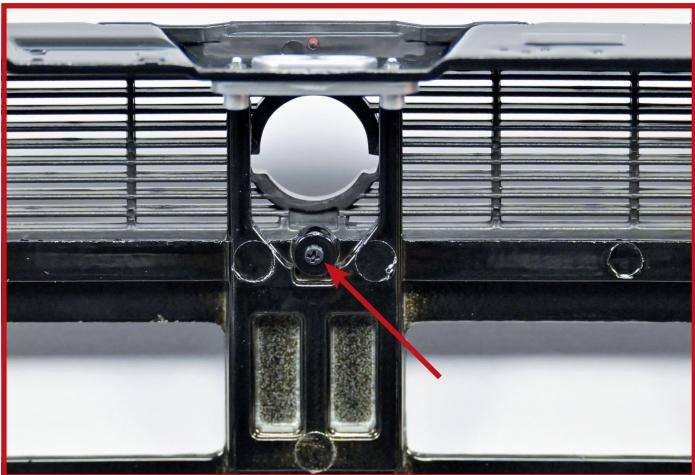
**5** Drehen Sie die Baugruppe um und halten Sie dabei den Kühlergrill in Position. Befestigen Sie ihn nun an der Frontmaske, indem Sie eine Schraube **PS12** in dem auf dem Foto markierten Loch festziehen.
