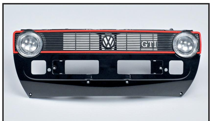
**BAUERGEBNIS:** So sieht die Frontmaske nach der Montage des Kühlergrills, der Scheinwerfer und des Volkswagen-Emblems aus. Bewahren Sie die Baugruppe zusammen mit den restlichen Teilen an einem sicheren Ort auf.
