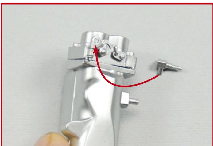
**6** Stecken Sie den Stift **10D** in die Aufnahme an den Ventilen **10E**, auf die der Pfeil weist.
