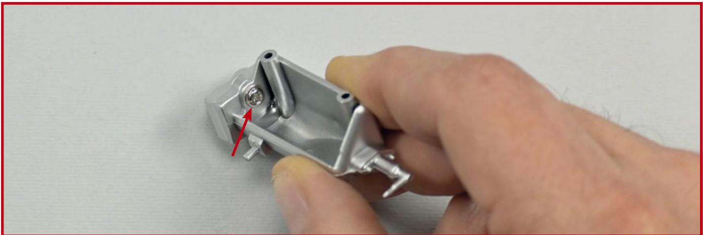
**3** Ziehen Sie eine Schraube **PS36** im gezeigten Loch fest, um die Teile zu fixieren.
