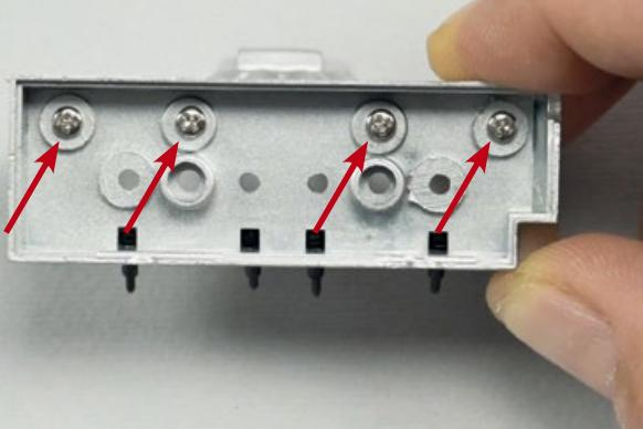
**10** Drehen Sie den Zylinderkopf um und ziehen Sie vier Schrauben **PS02** in den Löchern fest, auf die die Pfeile weisen.
