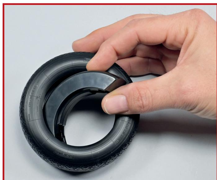
**1** Setzen Sie die innere Reifenhalterung **2E** in den Reifen **2I** ein. Um das Gummi formbarer zu machen, können Sie den Reifen mit einem Fön (oder einer anderen Wärmequelle) erwärmen.
