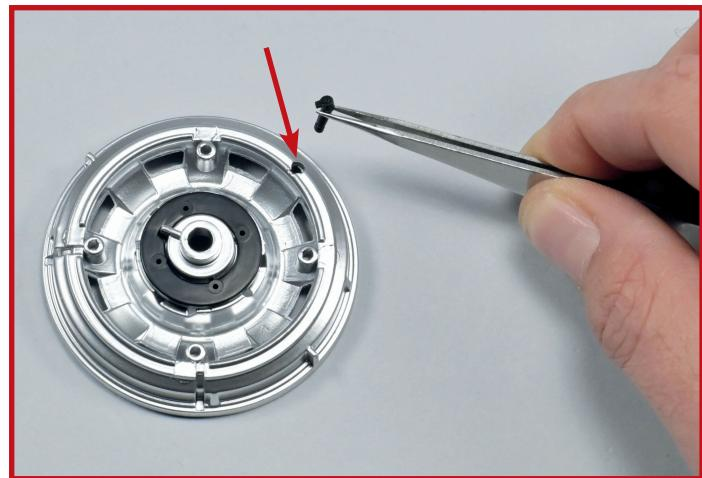
**8** Stecken Sie das Reifenventil **2D** in das entsprechende Loch an der Innenseite der Außenfelge **2A**. Drücken Sie das Ventil vollständig hinein, bis es fest sitzt.
