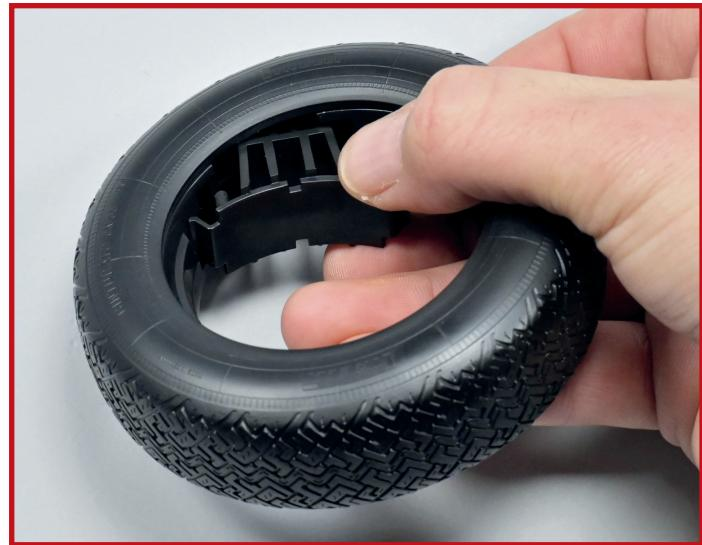
**4** Verbinden Sie die beiden Halterungen miteinander, indem Sie den Clip **2G** in die auf dem Foto gezeigte Stelle im Reifeninneren drücken.
