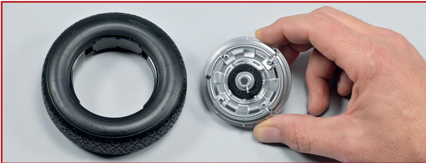
**9** Setzen Sie die Außenfelge auf den Reifen. Dazu führen Sie die beiden Stifte auf der Innenseite der Felge in die entsprechenden Öffnungen der Clips ein.
