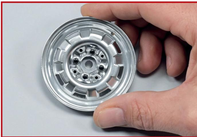
**7** So sieht die Außenseite der Felge **2A** aus, nachdem der Schraubenring korrekt montiert wurde.
