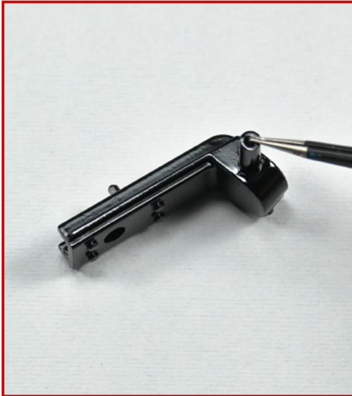
1 Die Halterung 25B verfügt über einen gebohrten Zapfen, der in die entsprechende Öffnung des vorderen linken Stützrahmens eingesetzt wird.
