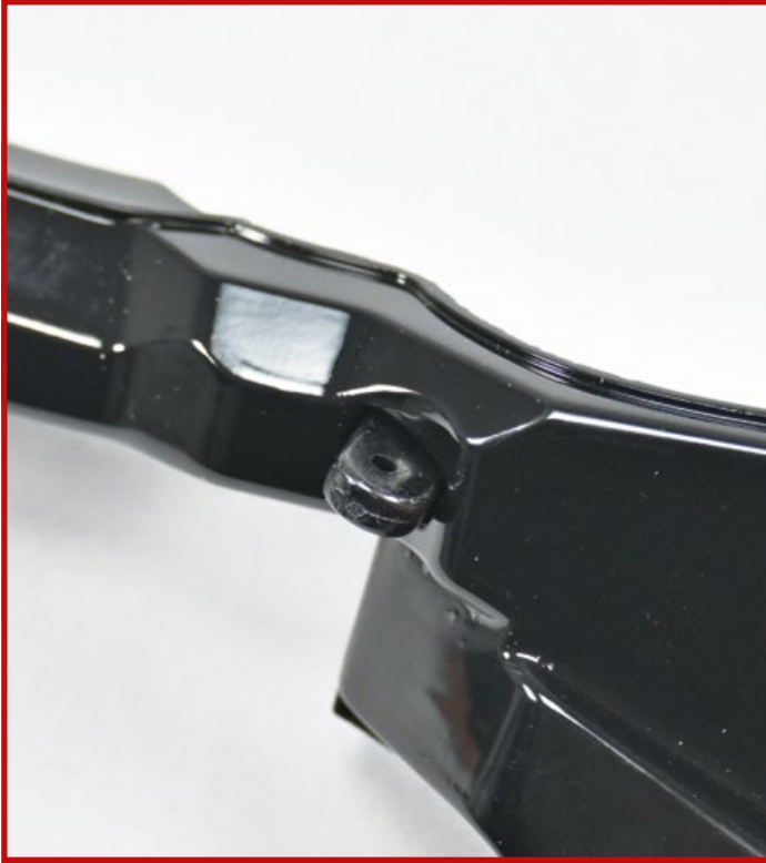
3 Setzen Sie die Halterung 27B am rechten Stützrahmen 27A ein.
