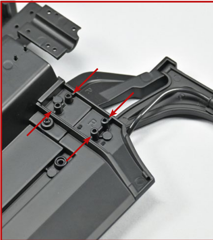
5 Nehmen Sie die Bodengruppe, an der Sie zuletzt in Ausgabe 26 gearbeitet haben. Die Pfeile im Bild weisen auf die Zapfen an der vorderen Bodengruppe 20A , auf welche die Aussparungen am flachen Endes des vorderen rechten Stützrahmens 27A passen.
