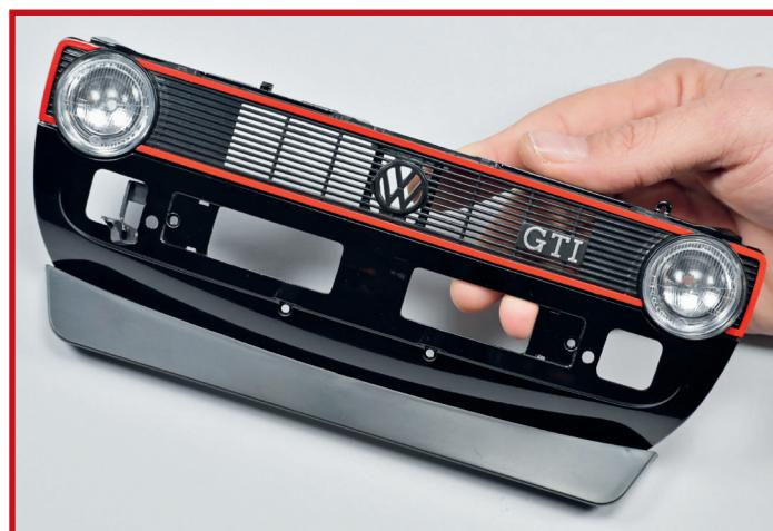
**13** Montieren Sie den Spoiler **3C** an der Frontmaske **1A** und richten Sie die Teile wie auf dem Foto gezeigt aus. Stecken Sie die beiden Stifte am Spoiler in die entsprechenden Löcher in der Frontmaske.
