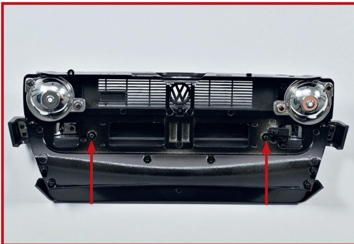
**16** Drehen Sie die Baugruppe um und achten Sie darauf, dass die Stoßstange an ihrer Position bleibt. Befestigen Sie die Teile aneinander, indem Sie zwei Schrauben **PS25** in den auf dem Foto gezeigten Löchern festziehen.
