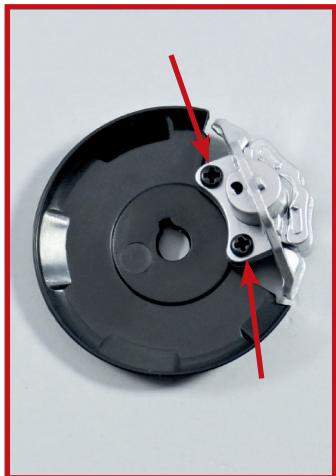
**22** Befestigen Sie die Komponenten mit zwei Schrauben **PS25**.
