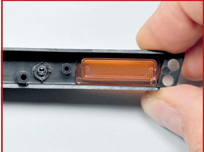
**5** Setzen Sie das rechte Blinkerglas **3I** (gekennzeichnet mit dem Buchstaben „R“) in die Öffnung auf der Innenseite der Stoßstange.
