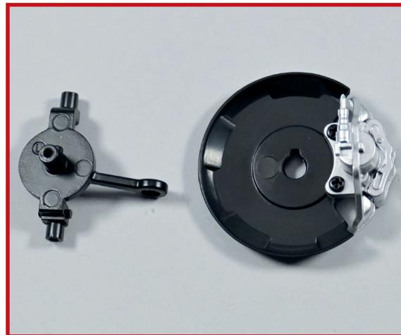
**24** Richten Sie den Stift des Achsschenkels **3P** samt Kerbe am Bremsträgerblech **3N** aus. Setzen Sie den Achsschenkel **3P** auf die Innenseite des Bremsträgerbleches **3N**.
