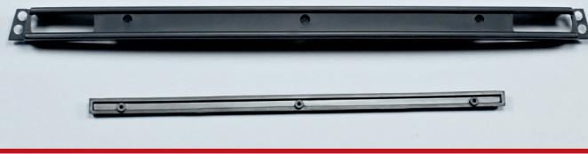
**3** Setzen Sie die Leiste **3B** auf die Außenseite der Stoßstange **3A**.
