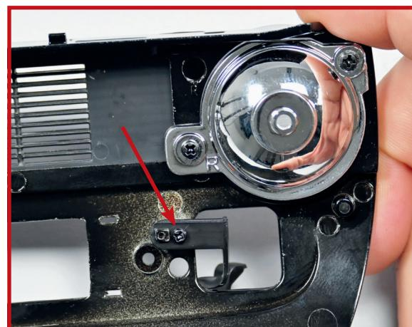
**2** Befestigen Sie die Öse mit einer Schraube **DS06**.
