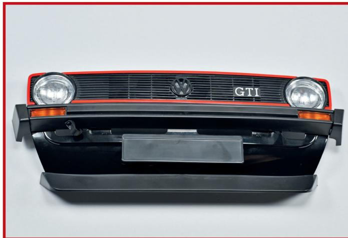
**17** Platzieren Sie den Kennzeichenhalter **3F** an der Außenseite der Frontmaske.
