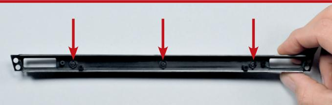
**4** Drehen Sie die Stoßstange um und achten Sie darauf, dass sich die Leiste nicht löst. Befestigen Sie die Stoßstange, indem Sie drei Schrauben **PS14** in den auf dem Foto markierten Löchern festziehen.
