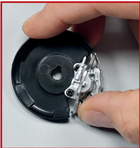
**23** Setzen Sie den Stift des Ventils **3G** in das halbmondförmige Loch des Bremssattels **3K**, wie auf dem Foto gezeigt.
