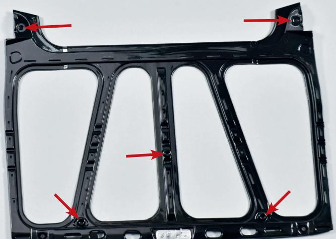
**7** Richten Sie die Unterseite der Motorhaube **4B** und den Rahmen **4A** wie auf dem Foto gezeigt aus. Passen Sie die fünf Löcher im Rahmen an die gebohrten Stifte der Motorhaube an.
