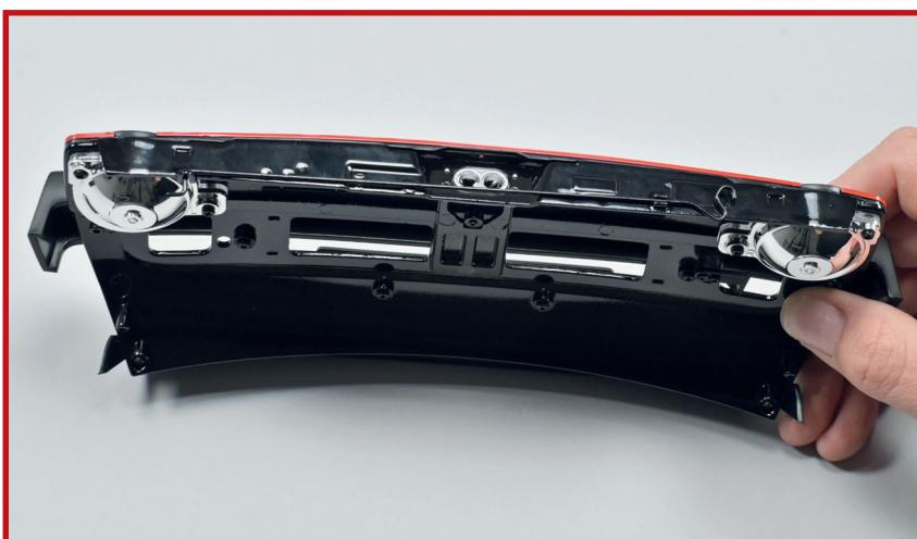
**11** Führen Sie die Haltestange bis zum oberen rechten Rand der Frontmaske und setzen Sie sie in die entsprechende Halterung ein. Richten Sie das gebogene Ende der Haltestange wie auf dem Foto gezeigt aus.
