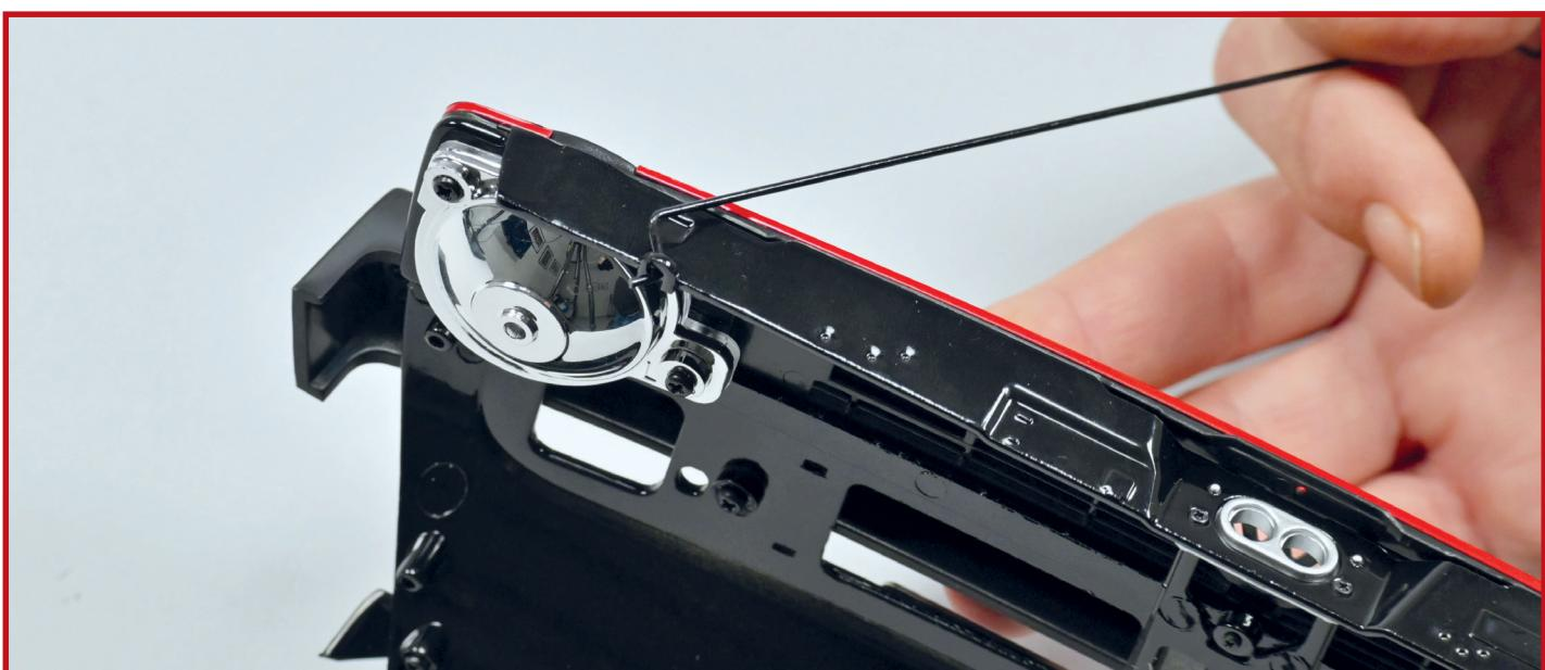
**10** Nehmen Sie die Frontmaske und das Vorderteil der Karosserie zur Hand, an dem Sie in Ausgabe 3 gearbeitet haben. Führen Sie das rechtwinklige Ende der Motorhauben-Haltestange **4D** in die perforierte Öse am oberen Rand der Frontmaske ein. Die Öse befindet sich über dem linken Frontscheinwerfer. Die Haltestange muss von außen nach innen in die Karosserie eingeführt werden wie gezeigt.
