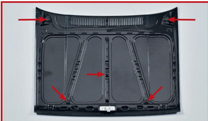
**8** Befestigen Sie den Rahmen an der Motorhaube, indem Sie fünf Schrauben **DS20** in den auf dem Foto gezeigten Löchern festziehen.
