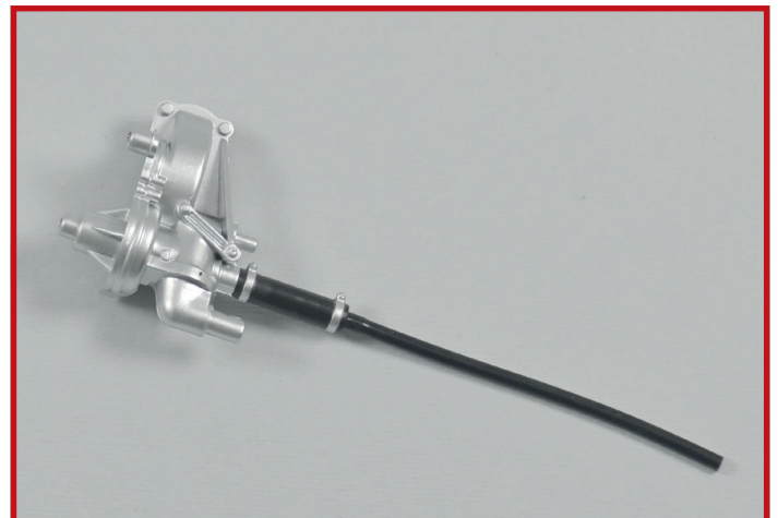
20 Setzen Sie die Hülse 6G wie gezeigt auf die Wasserpumpe 6A .
